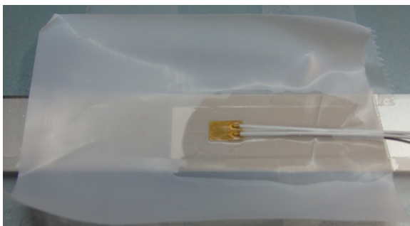
Obr. 26: Správně nalepený tenzometr
