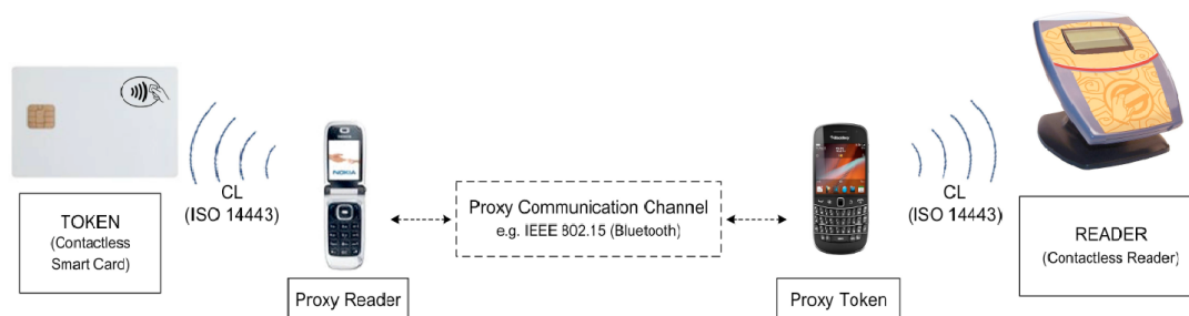
Obrázek 5 - Přepojovaný útok za pomoci dvou mobilních telefonů
