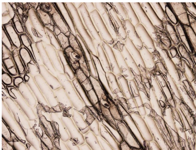
Obrázek 3.2e - VZOREK #6: P = 41,0 mW, t = 100 ms, h_4 = 1,00 mm
