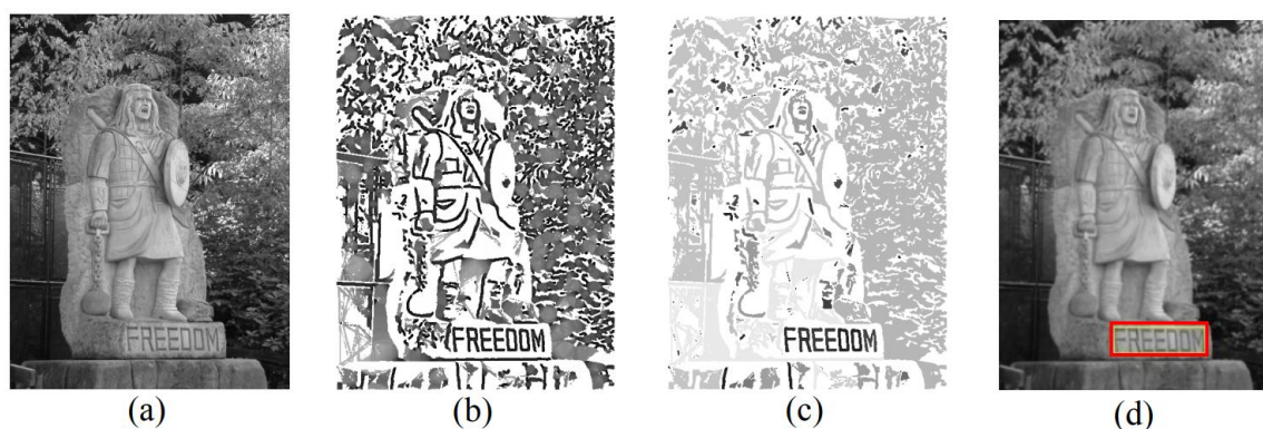
Obr. 5: Segmentace pomocí SWT (převzato z [22])
