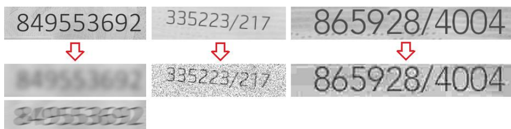
Obr. 78: Operace Gaussovského rozostření (vlevo uprostřed), pohybového rozostření (vlevo dole), přidání šumu (uprostřed) a JPEG komprese (vpravo)
