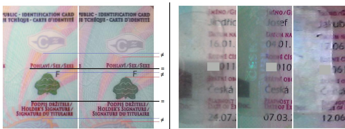
Obr. 42: Různé posunutí pozadí mezi průkazy (vlevo) a rušivý vliv ochranného hologramu (vpravo)
