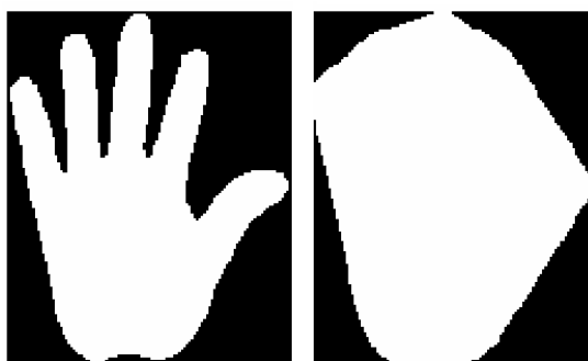
Obr. 12: Spojená komponenta (vlevo) a její konvexní obal (vpravo) – převzato z [30]
