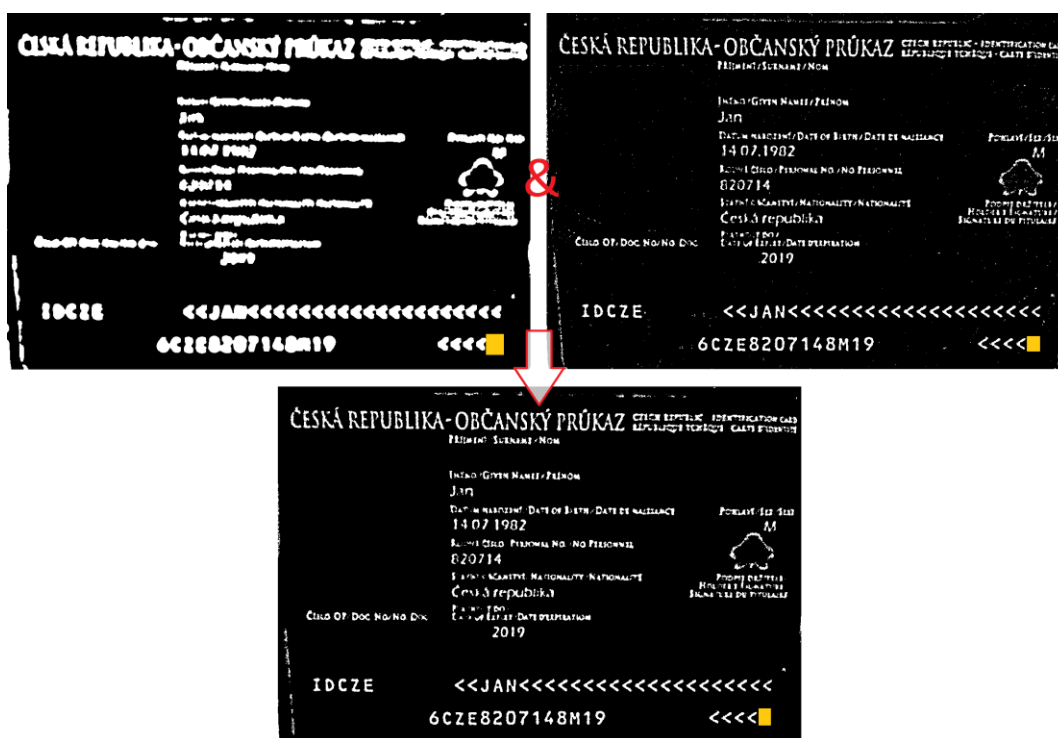
Obr. 59: Filtrace šumu a konečný výstup upraveného algoritmu pro adaptivní prahování
