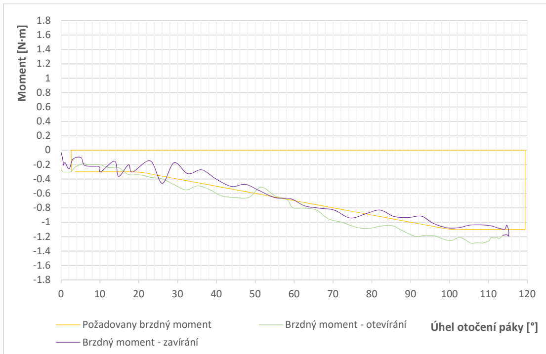
Obr. 59 Závislost generovaného brzdňého momentu na úhlu otočení páky GPA (GPA 3.1, Mode 2 linear, One direction)
