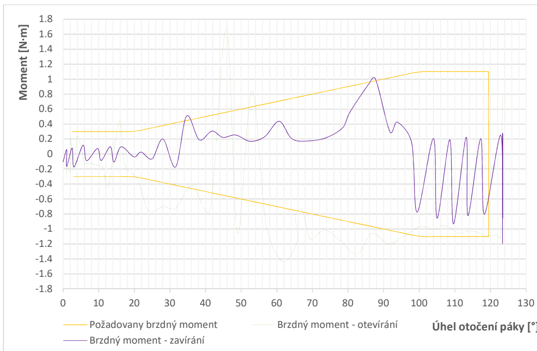
Obr. 61 Závislost generovaného brzdňého momentu na úhlu otočení páky GPA (GPA 3.1, Mode 2 linear, Switch polarity)
