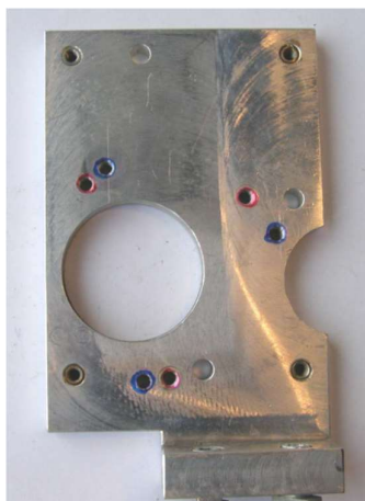
Obr. 16 Upínací deska – modře a červeně jsou označeny otvory pro uchycení dvou různých typů GPA [0].
