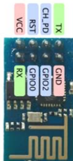
Obrázek M.2: Popis a zapojení pinů ESP-01 [44]
