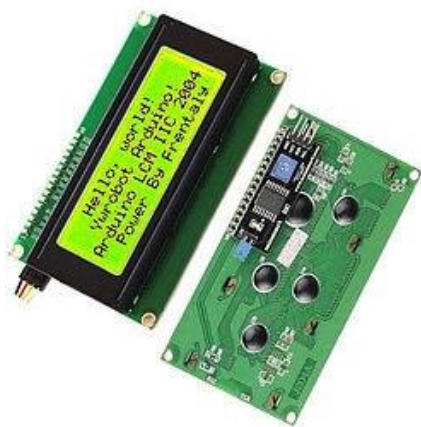
Obrázek J.2: LCD displej 20x4 znaků s rozhraním I2C [41]
