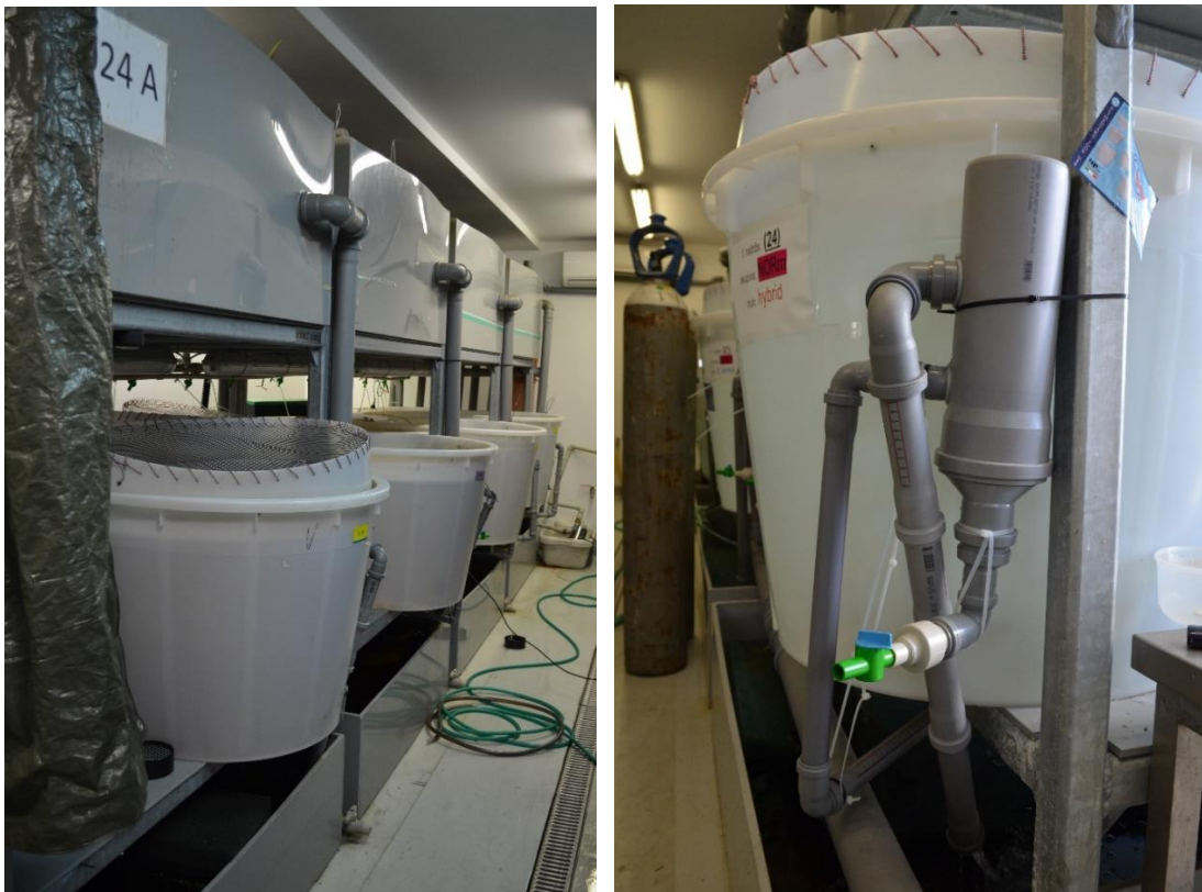
Obrázek č. 4: Systém pro odchov candáta, detail vortexu.
