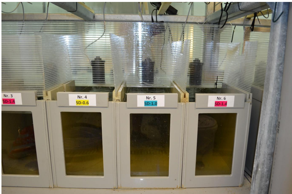
Obrázek 9: Detail nádrží s umístěnými sensory, pohled do nádrže.
