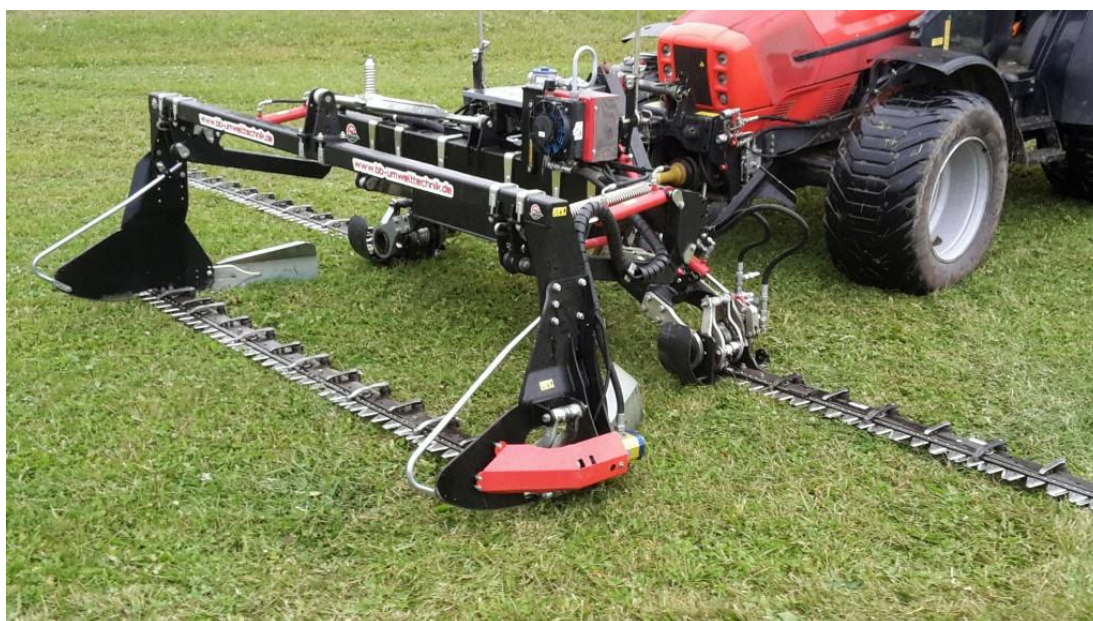
Obrázek 2 Žací lišty s protiběžnými kosami Seco Duplex od firmy BB – Umwelttechnik [6]
