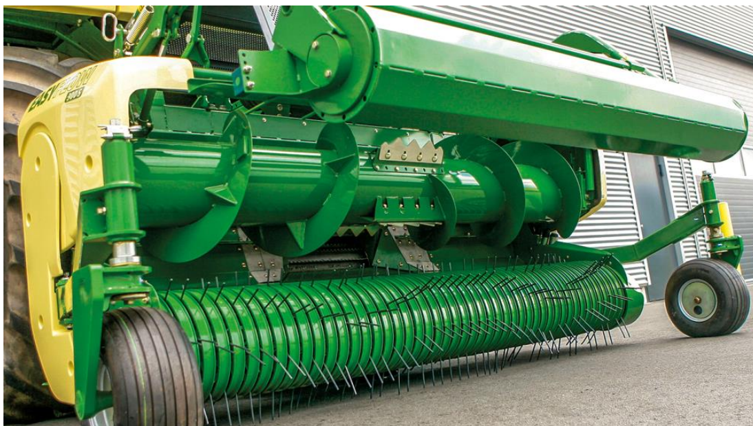
Obrázek 20 Sběrací adaptér EasyFlow od firmy Krone s neřízenou polohou sběracích pružin [21]
