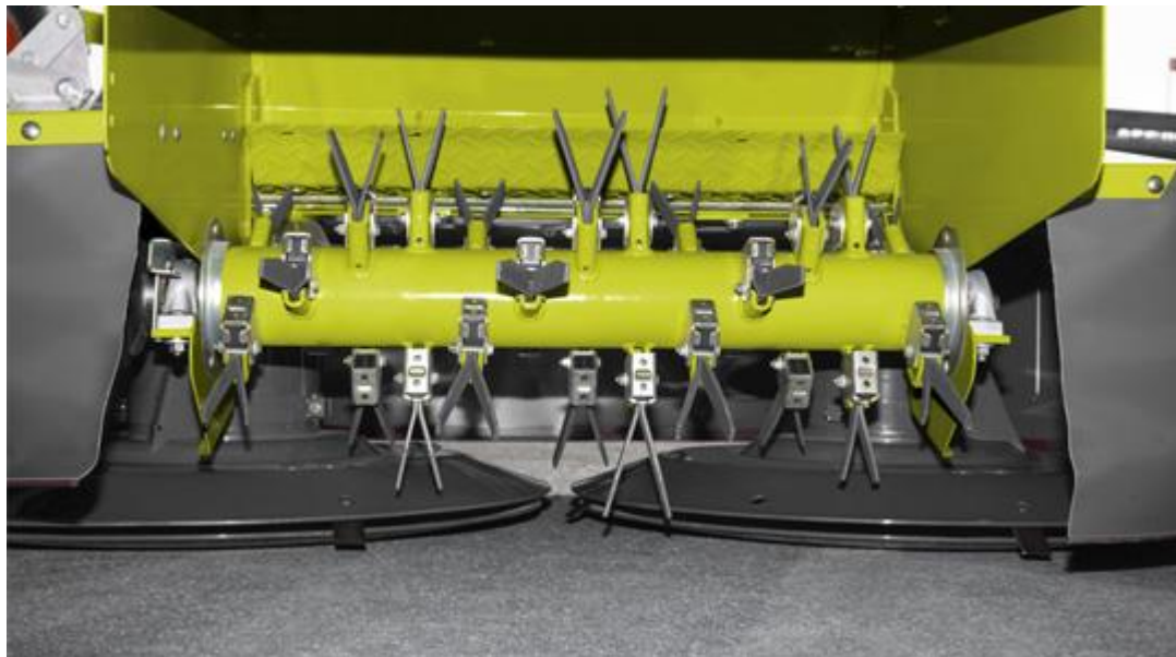
Obrázek 4 Bubnový žací stroj Corto od firmy Claas s prstovým kondicionérem [7]
