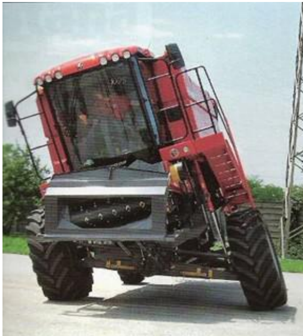
Obrázek 8 Příčné vyrovnání mlátičky [7]
