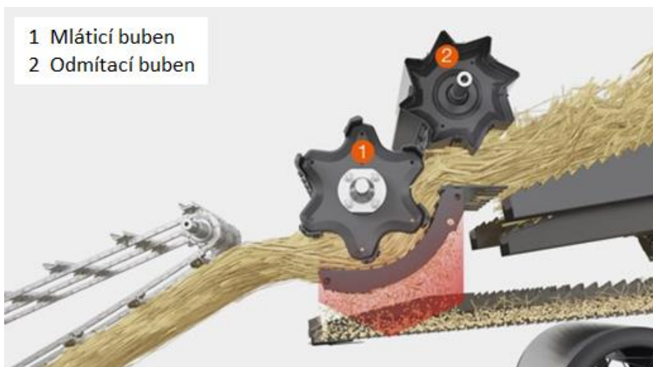
Obrázek 11 Mláčící ústrojí s odmítacím bubnem [23]
