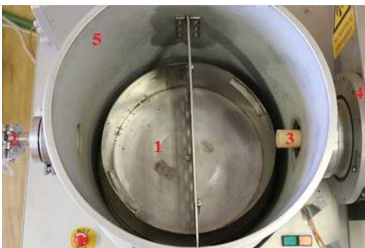
Obrázek 12: Vakuový recipient aparatury s míchacím zařízením
