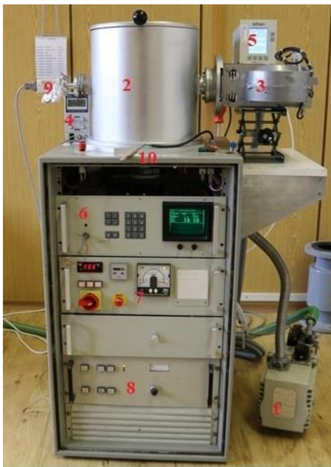
Obrázek 11: Nízkotlaká plazmová aparatura Plasonic AR-550-M
