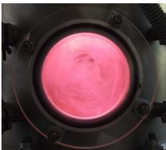
Obrázek 7: Depozice tenkých vrstev za pomoci plazmatu
