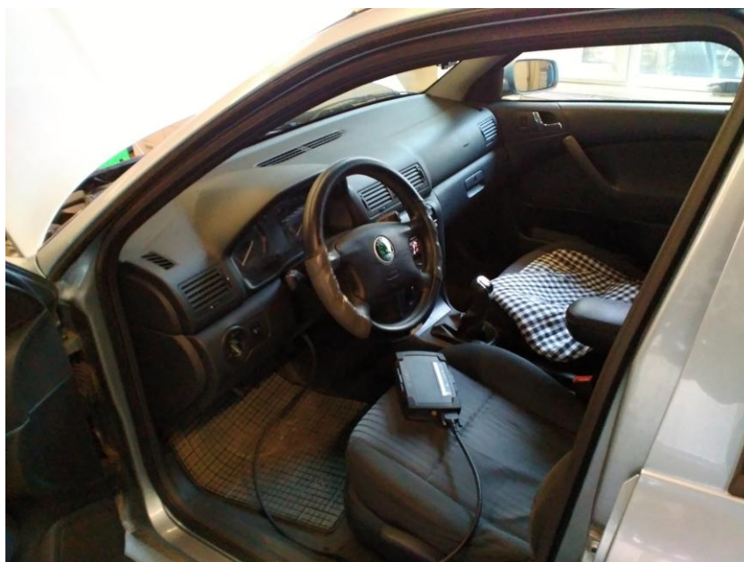
Obrázek č. 4 – Zařízení OBD pro připojení řídicí jednotky motoru vozidla, Zdroj: Autor (7. 2. 2018)
