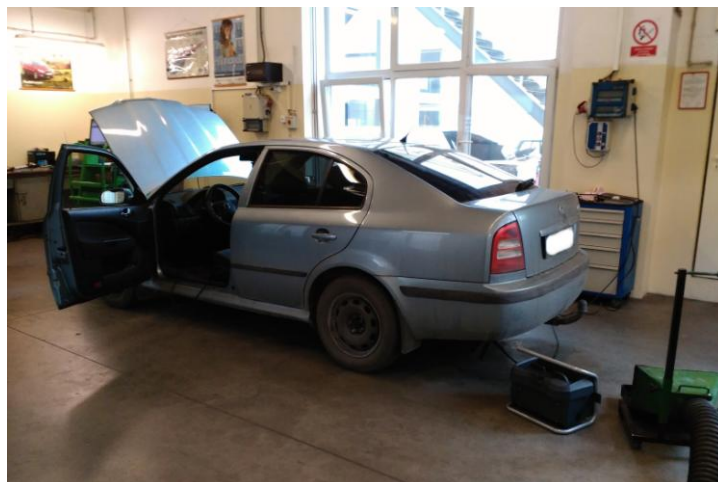
Obrázek č. 10 – Měření kouřivosti Škody Octavie, Zdroj: Autor (7. 2. 2018)
