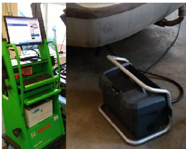
Obrázek č. 3 – Zařízení Bosch BEA 950 pro měření emisí vznětových motorů s analyzátozem výfukových plynů, Zdroj: Autor (7. 2. 2018)
