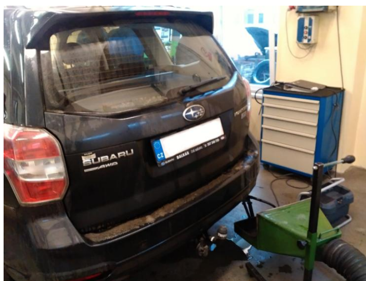
Obrázek č. 6 – Měření kouřivosti Subaru Forester, Zdroj: Autor (7. 2. 2018)
