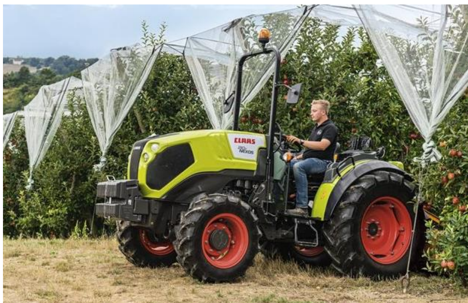
Obrázek č. 2 – Traktor s úzkým rozchodem kol Claas Nexos, zdroj: http://www.agrall.cz/novinka/781/nova-generace-traktoru-claas-nexos „staženo dne: 1. 10. 2017“
