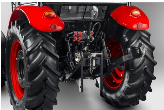
Obrázek č. 12 – Zadní zvedací závěs u traktoru Zetor Major, zdroj: http://www.agricosro.cz/eshop-traktor-zetor-major.html „staženo dne: 28. 2. 2018“
