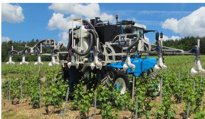
Obrázek č. 4 – Multifunkční portálový nosič nářadí BOBARD, zdroj: http://www.hmhadonin.cz/portalove-nosice „staženo dne: 1. 10. 2017“
