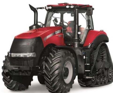
Obrázek č. 6 – Polopásový traktor Case IH Magnum Rowtrac HI-eSC, zdroj: http://www.agrics.cz/magnum-rowtrac-2 „staženo dne: 10. 10. 2017“
