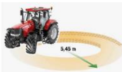
Obrázek č. 11 – Poloměr otáčení traktoru Case IH Puma 175 CVX, zdroj: FIREMNÍ LITERATURA CASE IH (2016)
