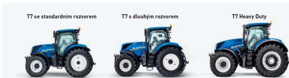
Obrázek č. 14 – Modelová řada traktorů New Holland T7 dle rozvorů, zdroj: FIREMNÍ LITERATURA NEW HOLLAND (2016)
