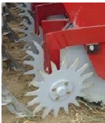
Obrázek 6: Dvojice odhrnovačů rostlinných zbytků na kypřiči STA-series od firmy Kongskilde. [12]
