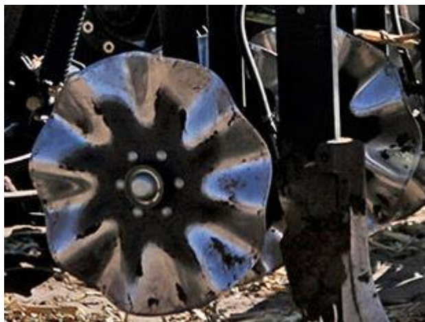
Obrázek 8: Dvojice vedle sebe situovaných tvarovaných vymežovacích kotoučů na kypřiči 1tRIPr od firmy Orthman. [14]
