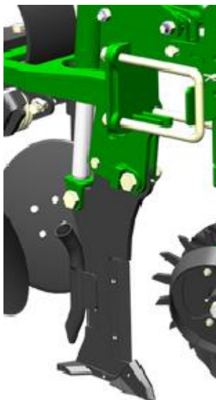
Obrázek 7: Použití radlice s postranními křídly na kypřiči Strip till plus od firmy Duro-France. [13]
