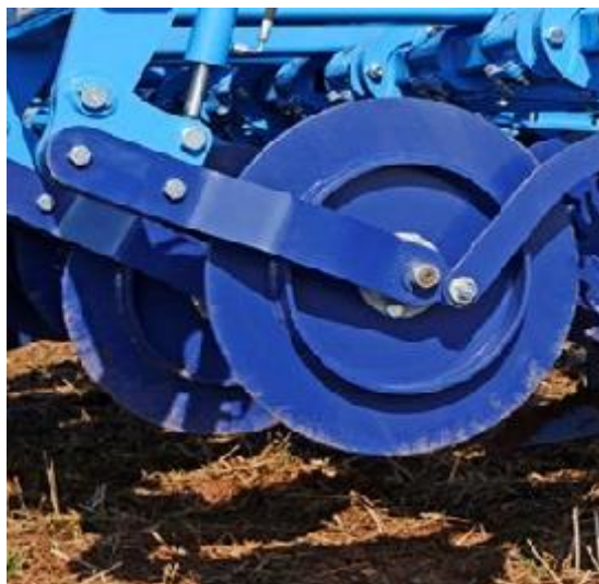
Obrázek 5: Prořezávací disk na kypřiči Strip-till české firmy Farmet. [11]
