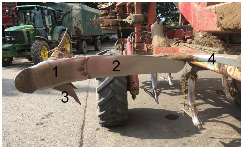
Obrázek 12 - Radlička MulchMix: 1 - radlička, 2 - odhrnovačka, 3 - křidélka, 4 - slupice.
