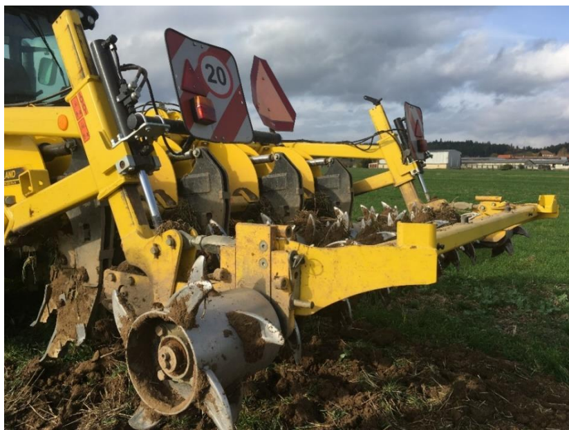
Obrázek 16 - Tandemové hrotové válce a systém nastavení pracovní hloubky
