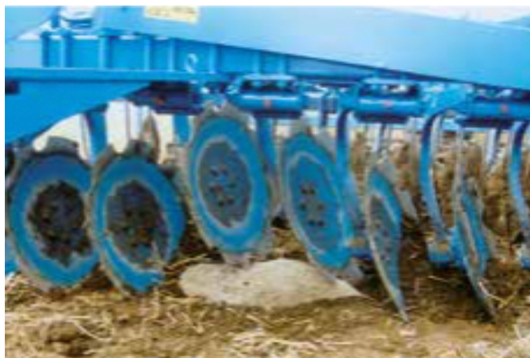
Obrázek 7 - Nezávislé zvednutí talířů při kontaktu s překážkou. [11]
