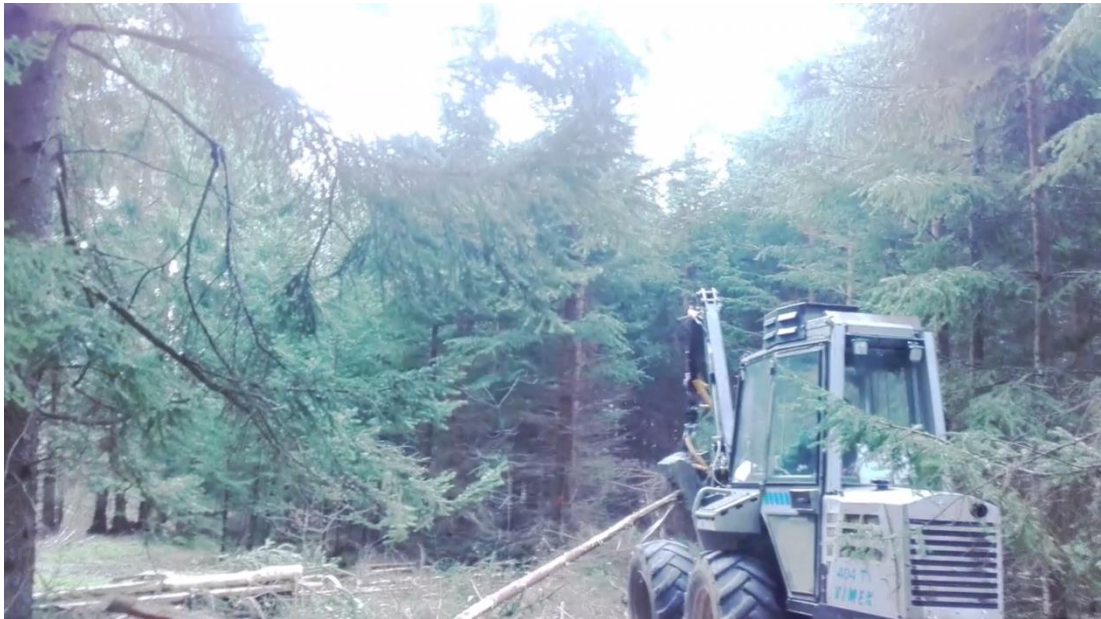
Foto 5 - Výjezd harvestoru z linky za účelem zpracování stromu, který měl větší průměr, než je požadovaný a tudíž bude nadále zpracováván odděleně.
