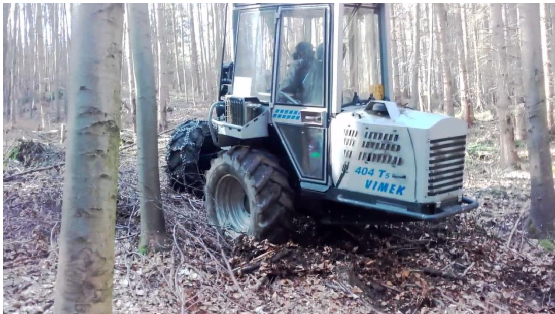
Obrázek 31 - Harvester na svažitém terénu - poškozování podloží
