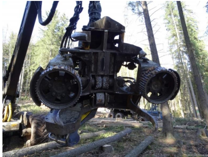
Obrázek 13 - Harvestorová hlavice finského typu
