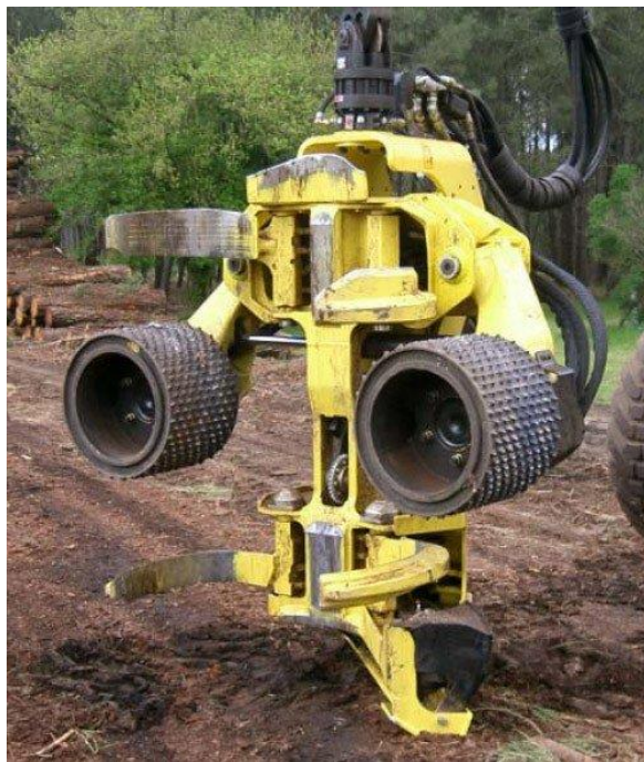
Obrázek 14 - Harvestorová hlavice švédského typu
