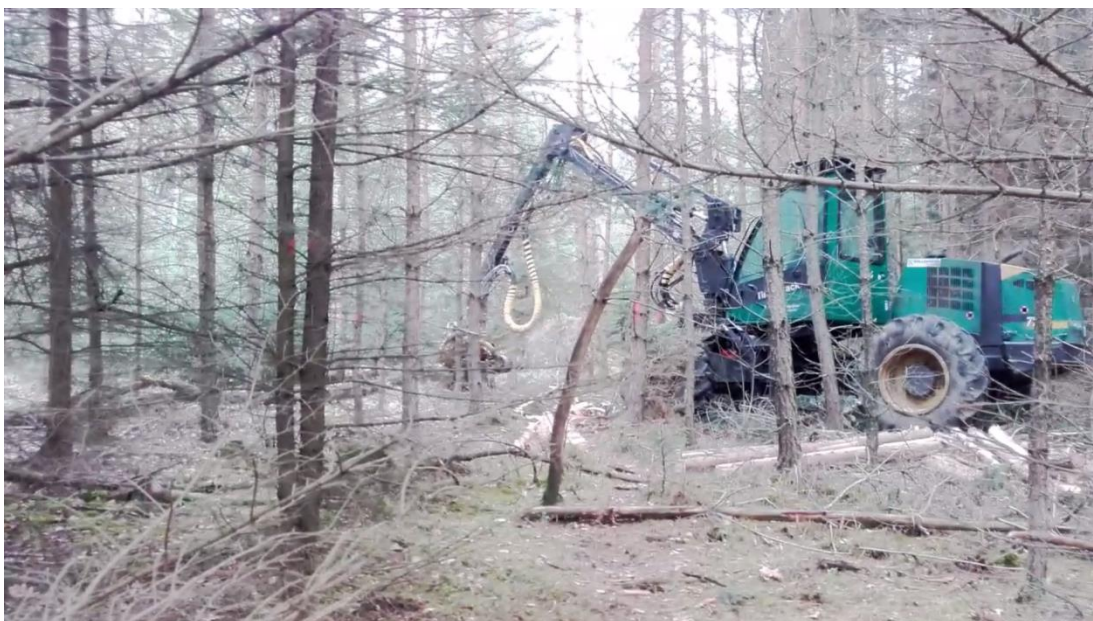
Foto 3 - Harvester při kácení (řezání).
