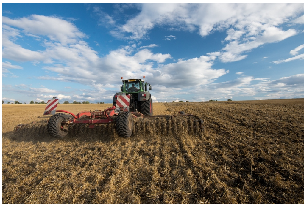
Obrázek 25 Zapravení posklizňových zbytků, Horsch Joker RT 8
