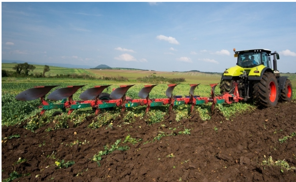
Obrázek 10 Oboustranný tažený pluh Kverneland PG 100.
