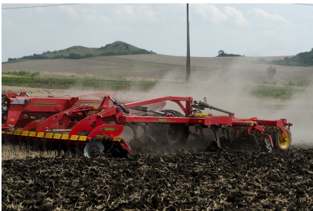
Obrázek 26 Zapravení posklizňových zbytků, TopDown TD 500
