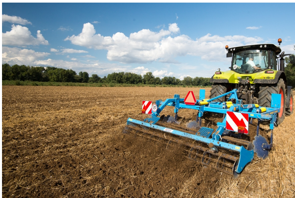
Obrázek 27 Zapravení posklizňových zbytků, Farmet Duolent DX 300 N
