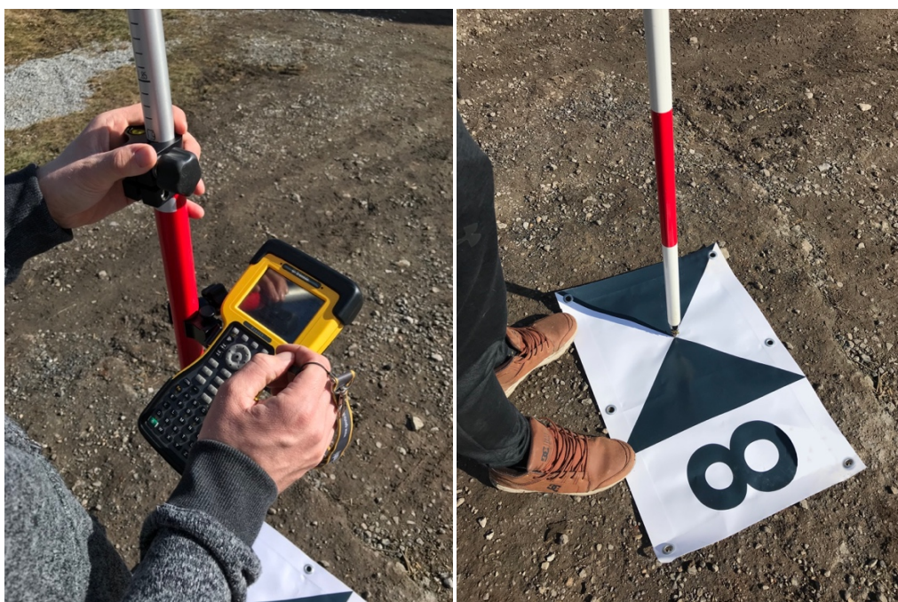
Obr. č.: 21 a 22: Přesné pozemní GPS zaměření vlčvacích bodů.
