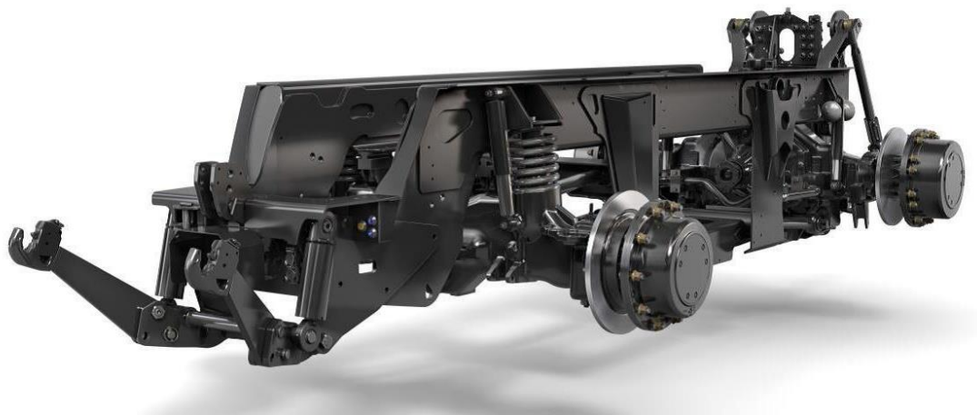
Obrázek 9: Rámová konstrukce traktorů JCB [14]
