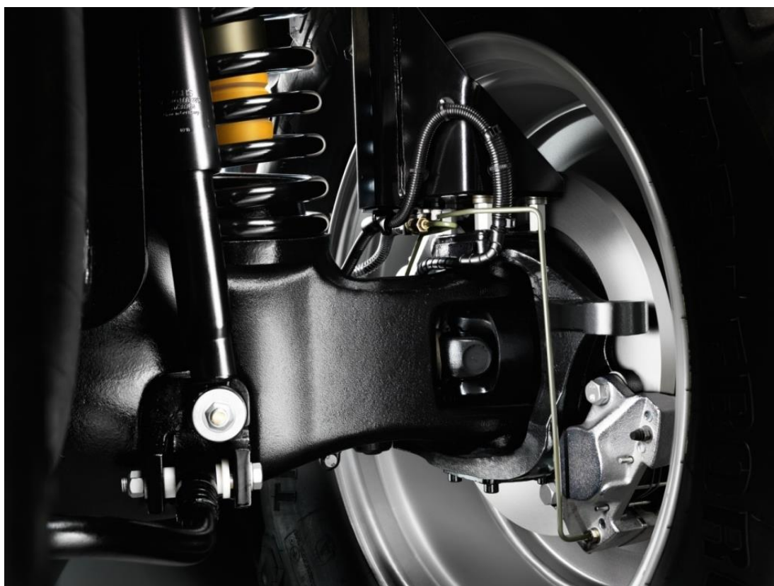
Obrázek 10: Odpružení přední nápravy vinutými pružinami a kotoučová brzda[14]
