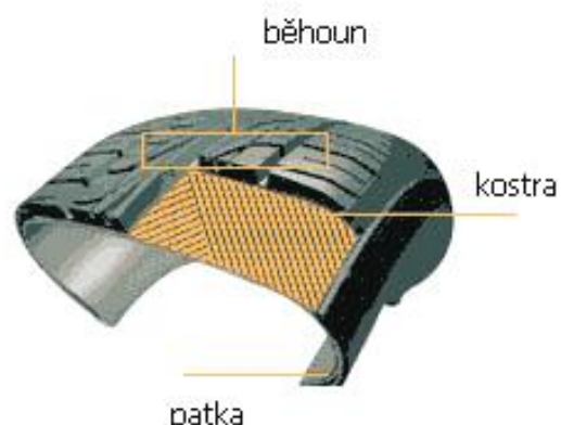
Obrázek 8 - Diagonální a Radiální pneumatika [13]
