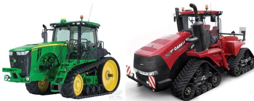
Obrázek 9 - Zleva podvozek s dvěma jednotkami a napravo se čtyřmi jednotkami [2]
