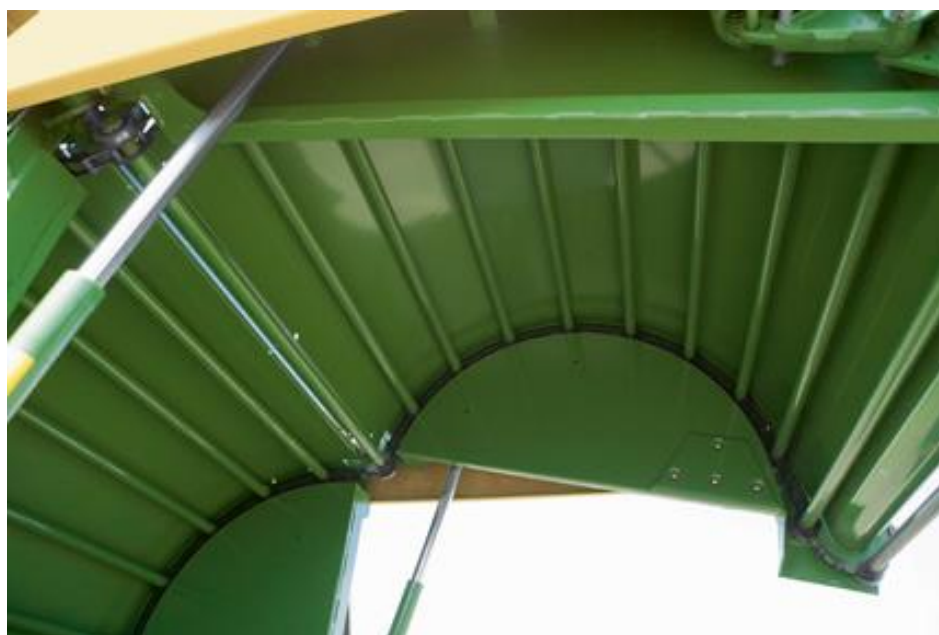
Obrázek 22 - Válečkový dopravník v pevné lisovací komoře (zdroj: http://landmaschinen.krone.de/%C4%8Desky/vyrobni-program/krone-lisy-na-valcove-baliky/bellima/prickovy-retezy-dopravnik/ , „staženo dne: 25. 2. 2018“)
