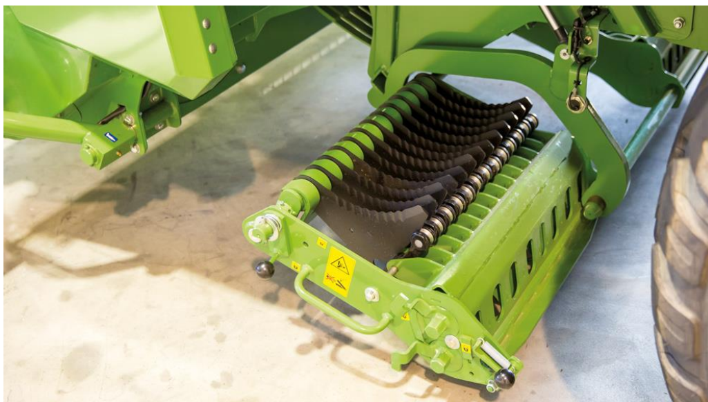
Obrázek 8 - Výsuvná kazeta s řezacími noži (zdroj: http://landmaschinen.krone.de/%C4%8Desky/vyrobni-program/lisy-na-velke-baliky/big-pack/krone-x-cut/ , „staženo dne: 21. 2. 2018“)
