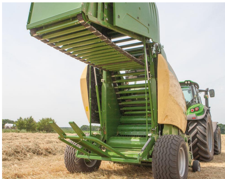
Obrázek 19 - Příčkový dopravník KRONE Novogrip (zdroj: http://landmaschinen.krone.de/%C4%8Desky/vyrobni-program/krone-lisy-na-valcove-baliky/comprima/novogrip/ , „staženo dne: 25. 2. 2018“)
