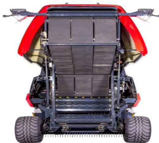
Obrázek 18 - Nekonečné gumové pásky v lisovací komoře (zdroj: https://www.poettinger.at/cs_cz/Produkte/Detail/345/impress-v-s-variabilni-lisovaci-komorou , „staženo dne: 25. 2. 2018“)
