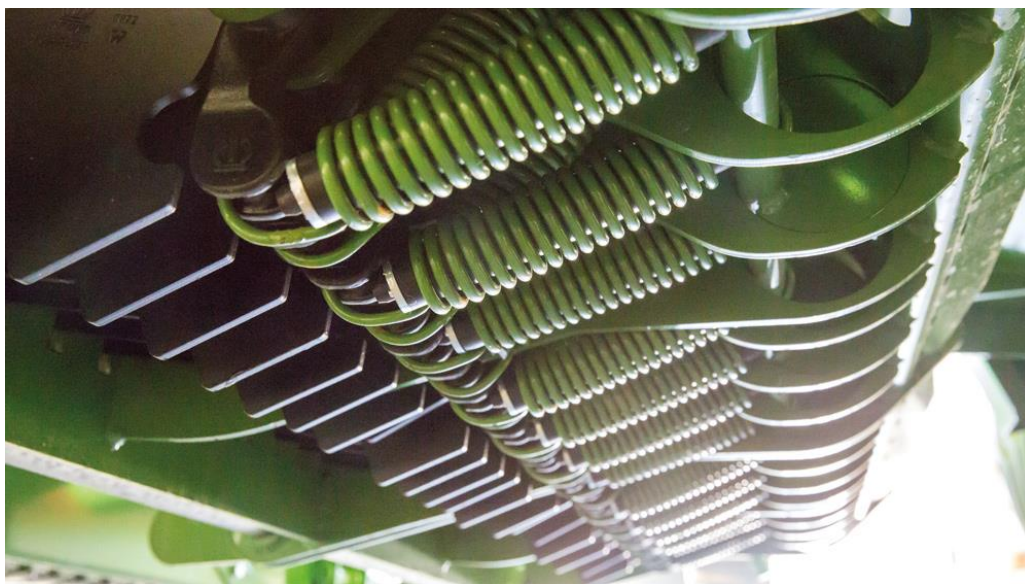
Obrázek 9 - Jištění řezacích nožů pružinami (zdroj: http://landmaschinen.krone.de/%C4%8Desky/vyrobni-program/lisy-na-velke-baliky/big-pack/krone-x-cut/ , „staženo dne: 21. 2. 2018“)
