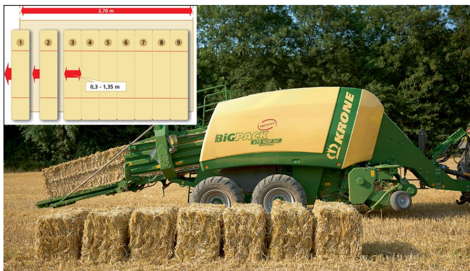
Obrázek 14 - Systém MultiBale firmy Krone (zdroj: http://landmaschinen.krone.de/%C4%8Desky/vyrobni-program/lisy-na-velke-baliky/big-pack/krone-multibale/ , „staženo dne: 25. 2. 2018)
