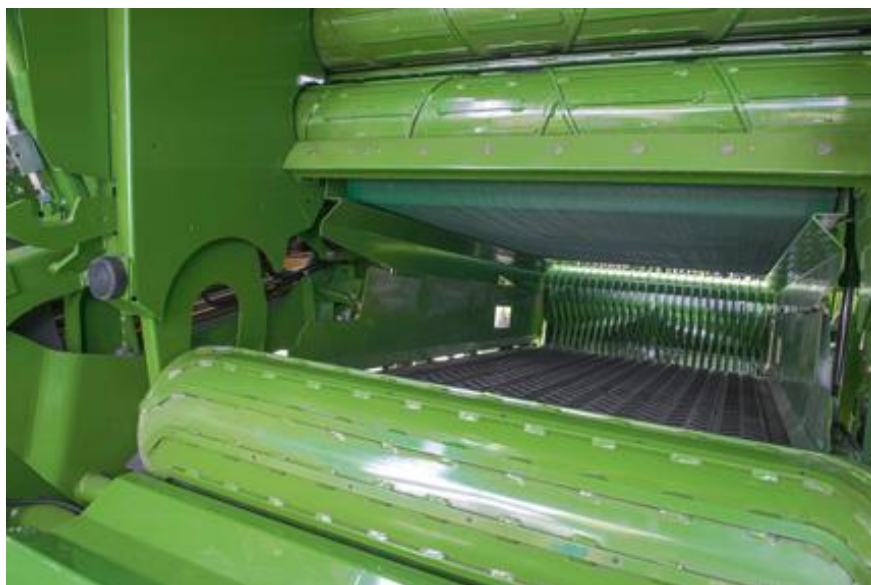
Obrázek 16 - Zásobní komora lisu KRONE Ultima (zdroj: http://landmaschinen.krone.de/%C4%8Desky/vyrobní-program/krone-lisy-na-valcove-baliky/ultima/jedinecny-pouze-od-krone/ , „staženo dne: 25. 2. 2018“)
