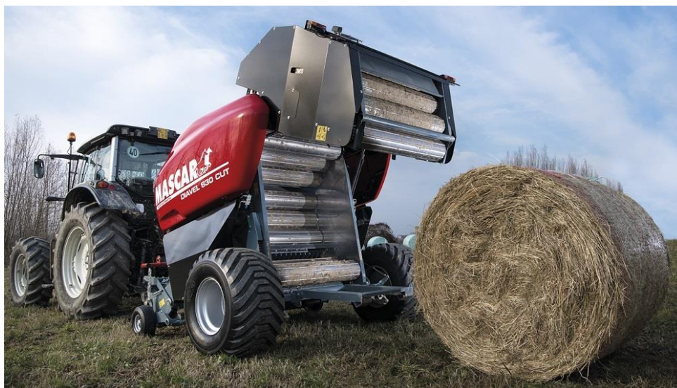
Obrázek 21 - Pevné profilové válce v lisovací komoře (zdroj: http://www.unimarco.cz/25810-lis-diavel , „staženo dne: 25. 2. 2018“)
