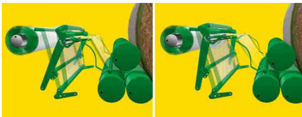
Obrázek 25 - Ovazování balíku do sítě – dokončení: vlevo – vázací poloha, vpravo – poloha při odříznutí, (zdroj: FRÍD, 2015, s.23)
