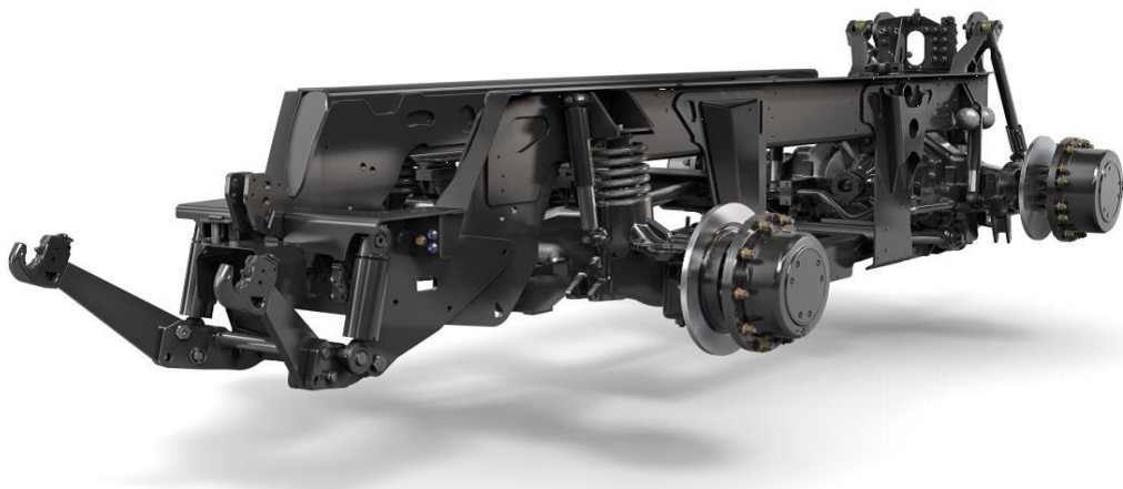
Obrázek 3 – Rámová konstrukce podvozku Fastrac [8].
