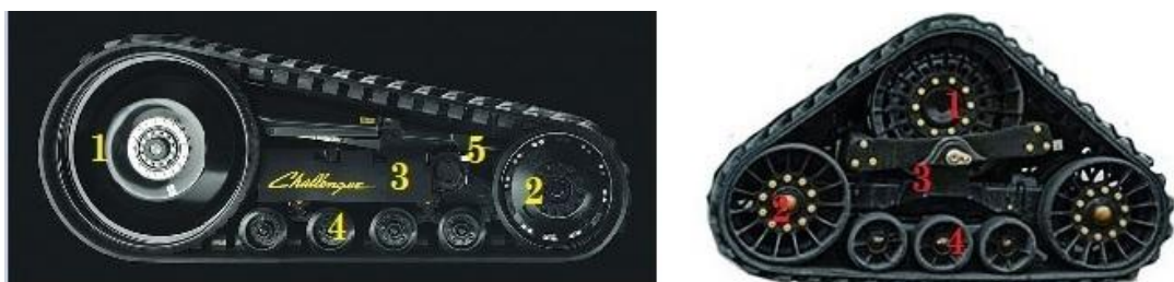
1 - hnací kolo, 2 - napínací kolo, 3 - centrální nosník, 4 - středové vodící kladky, 5 - napínací mechanismus
