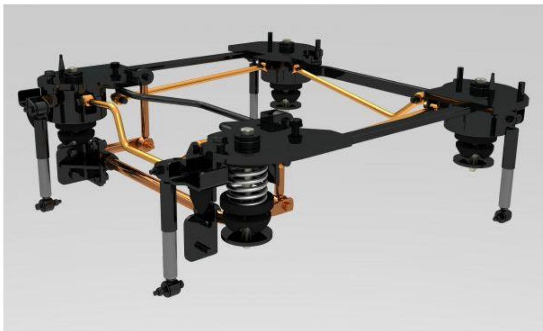
Obrázek 20 – Odpružení kabiny Case Quadtrac [31].
