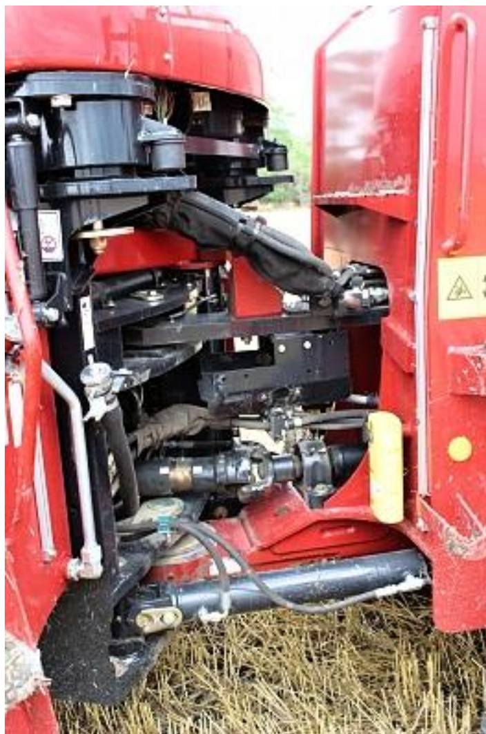
Obrázek 28 – Kloubové spojení Case Quadtrac [35].
