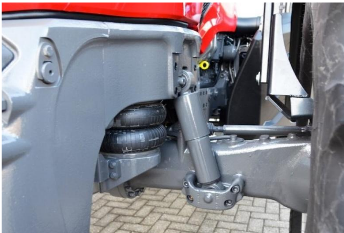
Obrázek 5 – Pneumatické odpružení přední nápravy [10].
