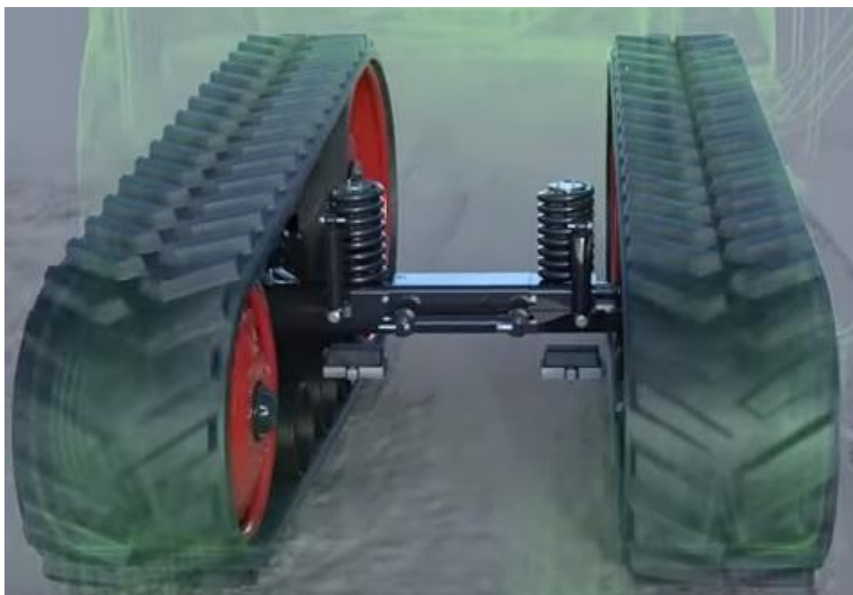
Obrázek 15 – Odpružení pásového podvozku Fendt MT [5].
