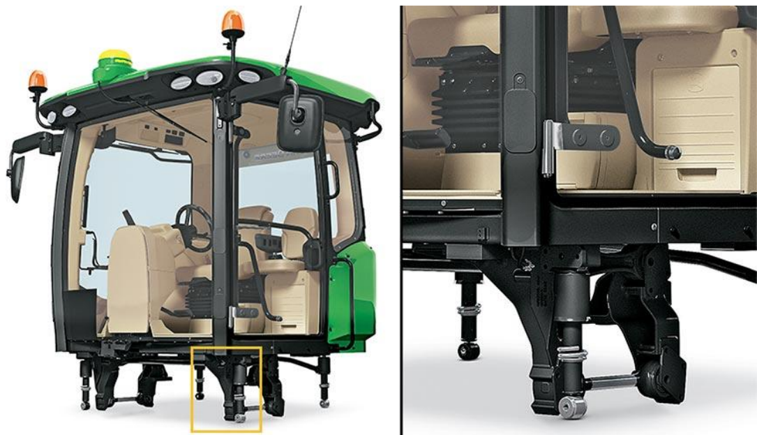
Obrázek 19 – Odpružení kabiny John Deere 9 RX [27].
