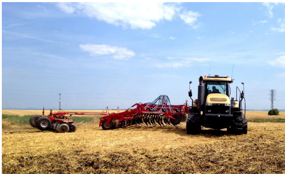
Obrázek 37 – Hlubkový kypřič Horsch Tiger AS v agregaci s pásovým traktorem Challenger MT 865C.
