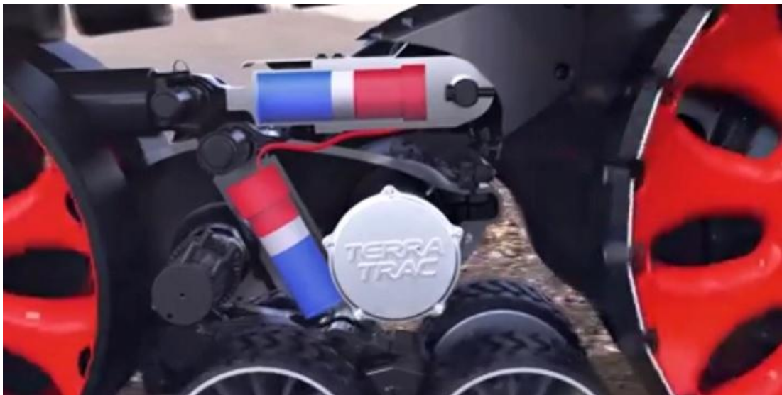
Obrázek 32 – Hydro-pneumatické odpružení Terra Trac [42].
