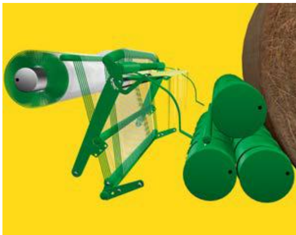
Obrázek č. 13 – Vázání do sítě, poloha na začátku vázání,
