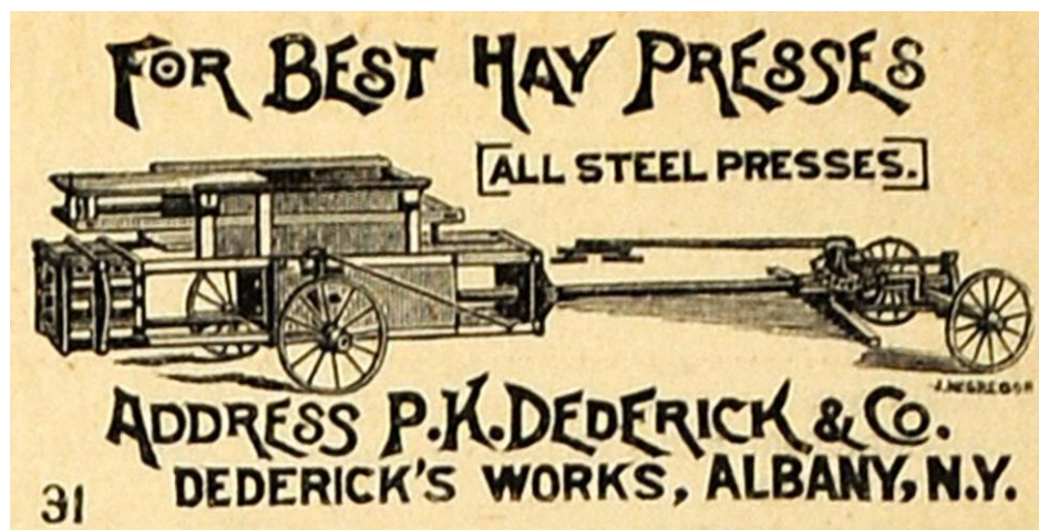
Obrázek č. 1 – Kontinuální lis sestrojený P. K. Dederickem,
