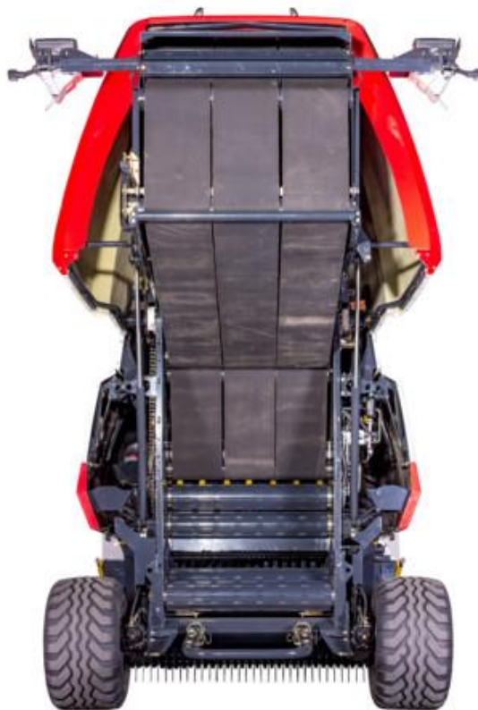
Obrázek č. 11 – POTTINGER IMPRESS s variabilní lisovací komorou, zdroj: https://www.poettinger.at/cs_cz/Produkte/Detail/345/impress-v-s-variabilni-lisovaci-komoru#groupTH-29 , „staženo dne: 14. 11. 2017“
