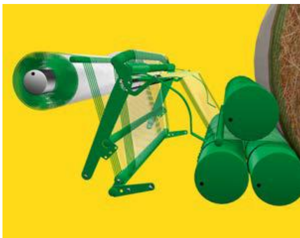
Obrázek č. 15 – Vázání do sítě, vázací poloha,
