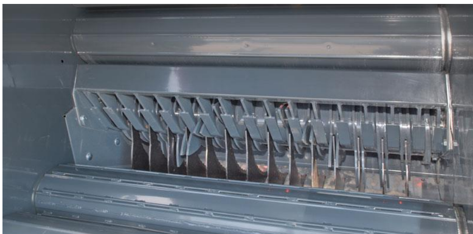
Obrázek č. 10 – Řezací ústrojí firmy POTTINGER, zdroj: http://www.poettinger.at/img/landtechnik/rundballenpressen/rollprofi_supercut.jpg , „staženo dne: 10. 11. 2017“
