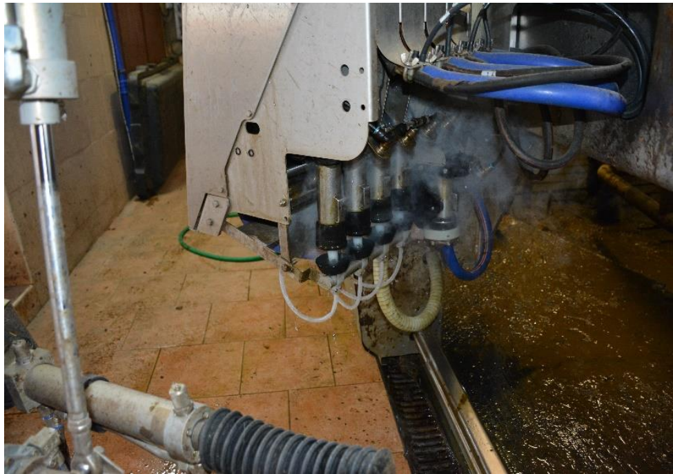
Obrázek č. 14 Čištění strukových násadců párou v boxu pro strukové násadce
