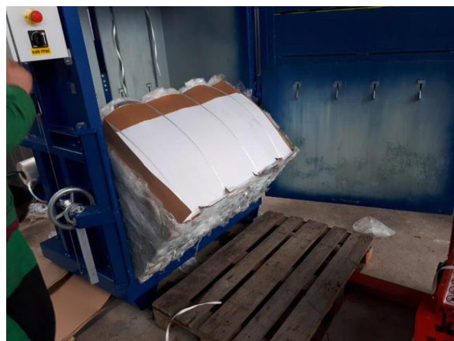
Obrázek 20: Fotografie č. 10 - Slisovaná čirá folie - váha balíku cca 120 kg
