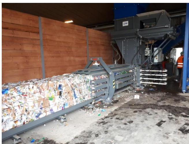
Obrázek 34: Fotografie č. 24 - Pohled na lis a perforátor pet lahví - hotové slisované balíky
