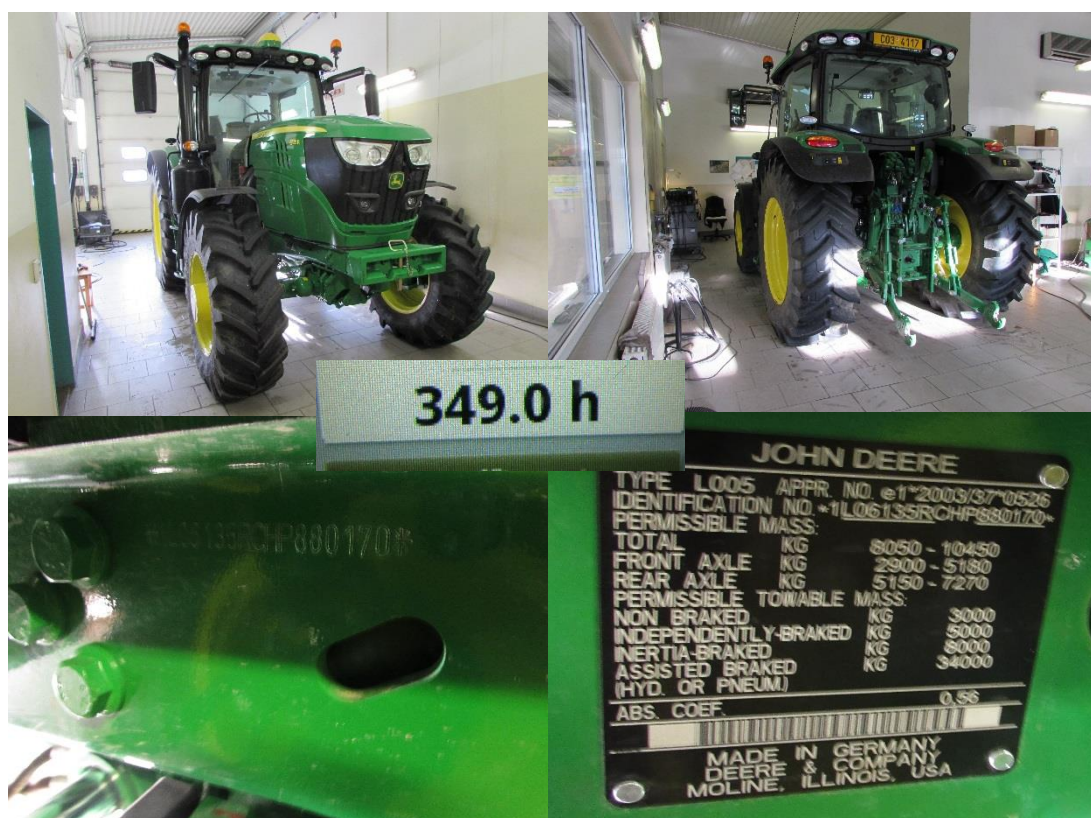
Obrázek č. 14 – Části traktoru, které se musí při STK a ME fotit
