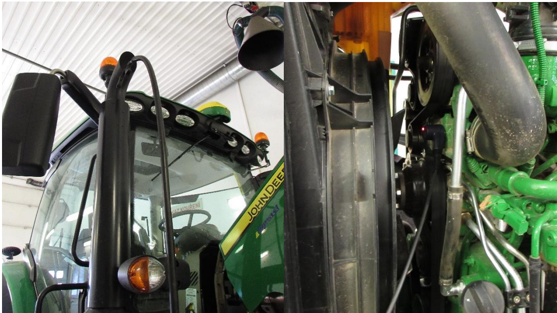
Obrázek č. 15 – Připojení sondy opacimetru a snímače otáček motoru
