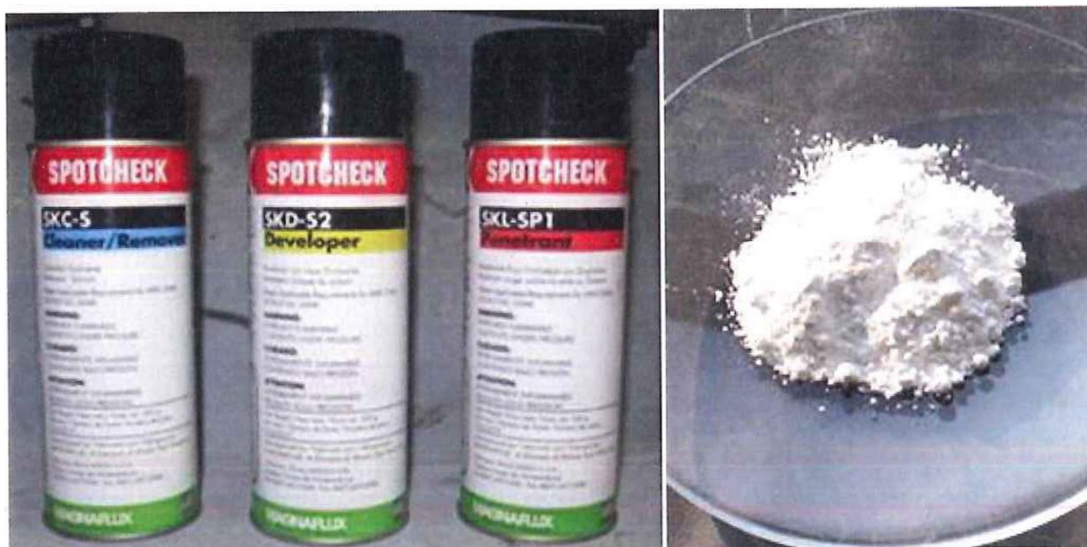
Obrázek č. 15 – Sada prostředků k realizaci kapilární zkoušky, zdroj: MUSIL a MORAVEC (2017)
