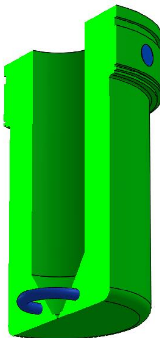
Obr. č. 18 Temperování vtokového ústí
