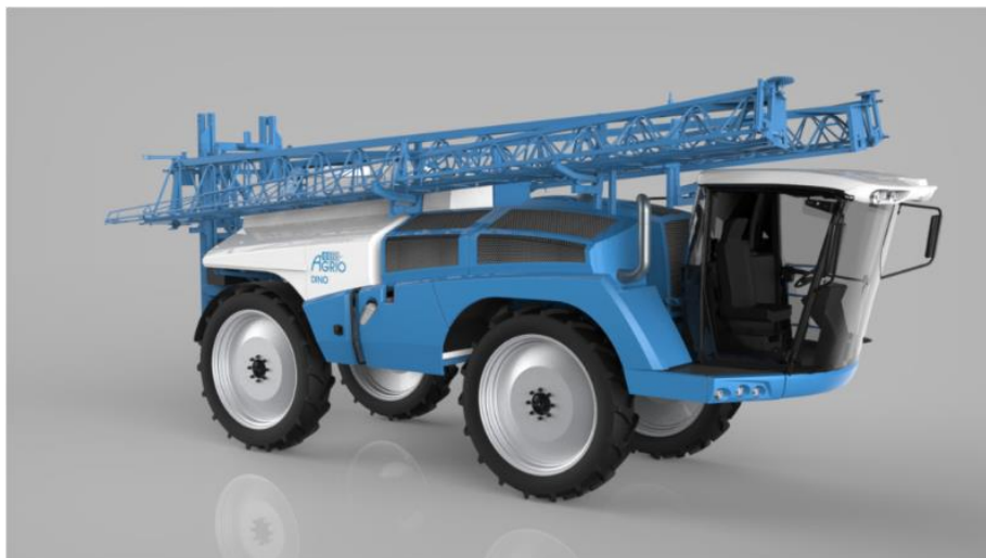
Obrázek 4: Samojízdný postřikovač DINO výrobce Agrio MZS s.r.o., zdroj: [17]
