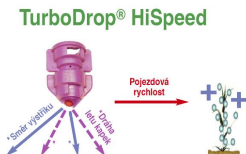
Obrázek 9: Ošetření dvouštěrbínovou tryskou s asymetrickým rozložením směrů a symetrický dopad účinné látky, zdroj: [29]
