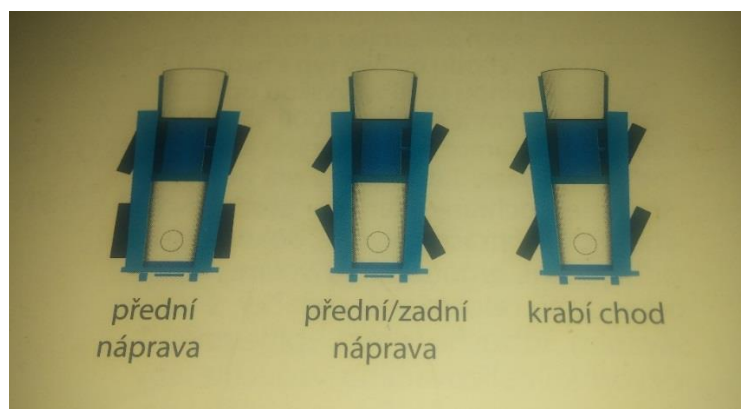
Obrázek 6: Varianty řízení samojízdného postřikovače (pohled shora), zdroj: [7]
