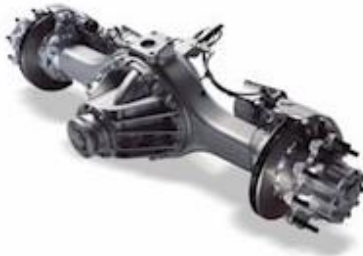
Obrázek 28: Zadní náprava autobusů DAF, zdroj: Dafcomponents.com
