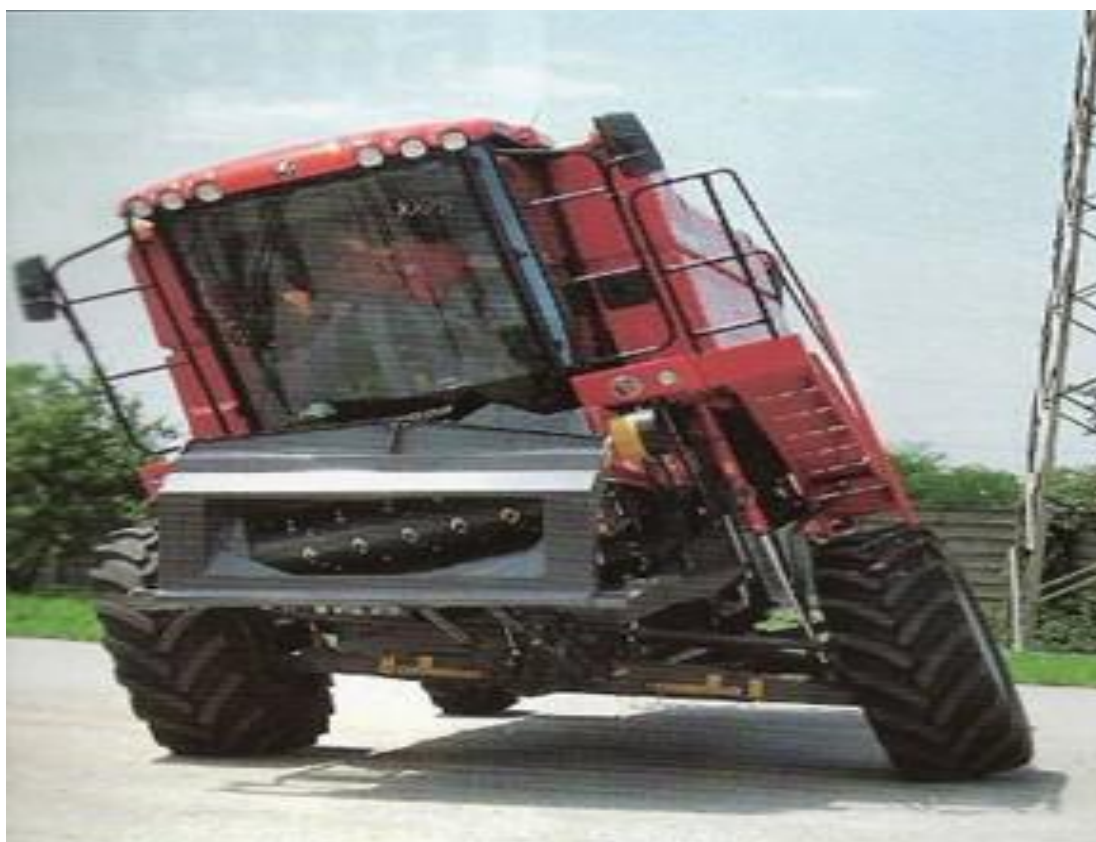
Obrázek 7 Příčné svahové vyrovnání sklízecí mlátičky [21]
