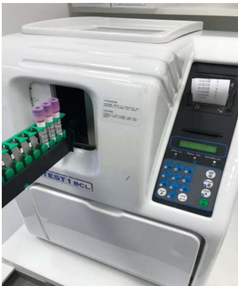
Obr. 19: Analyzátor Alifax Test 1 BCL s vkládaným rackem s krvemi pacientů Zdroj: Autor
