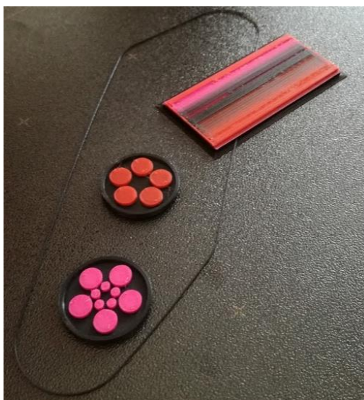
Obrázek 21: Hotový výtisk žetonů s použitím MMU2
