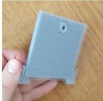
Obrázek 61: Vytisknuté víčko s podporami
