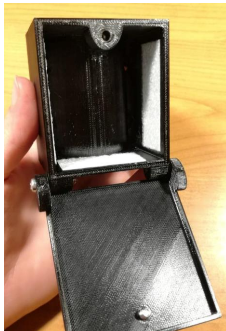
Obrázek 75: Vnitřní prostor krabičky z materiálu PETG
