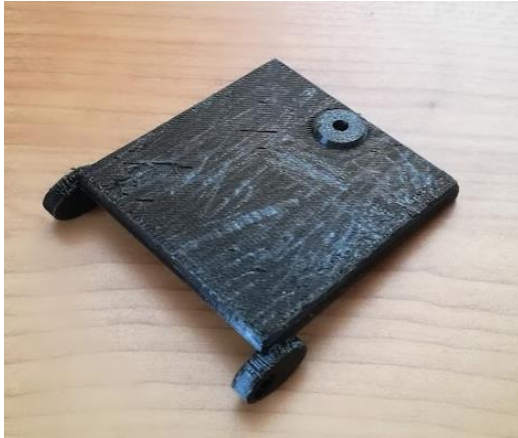
Obrázek 78: Víčko po odstranění podpor po tisku ve stejné pozici jako při tisku z materiálu PLA
