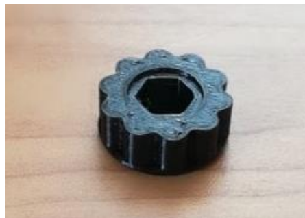
Obrázek 73: Vytisknutá zajišťovací matka
