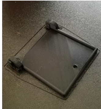
Obrázek 71: Vytisknuté víčko s podporami
