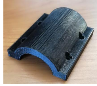
Obrázek 66: Objímka po odstranění podpor
