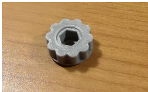
Obrázek 63: Vytisknutá zajišťovací matka
