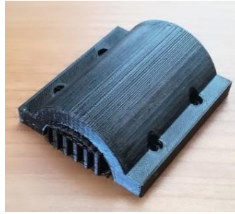
Obrázek 65: Vytisknutá objímka s podporami
