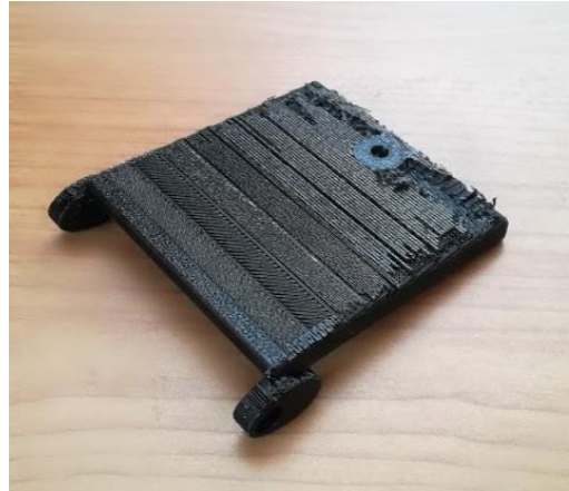
Obrázek 79: Víčko po odstranění podpor po tisku v nakloněné pozici
