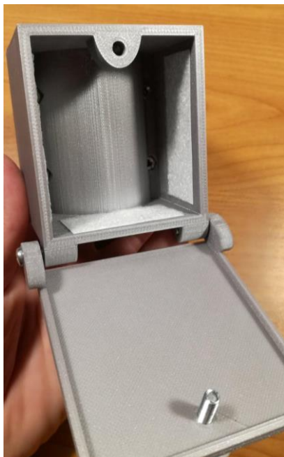
Obrázek 74: Vnitřní prostor krabičky z materiálu PLA
