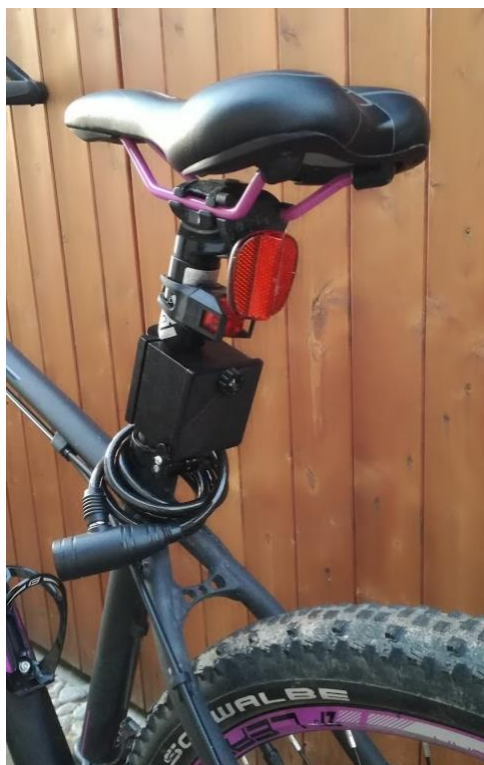
Obrázek 77: Umístění krabičky z PETG na kole
