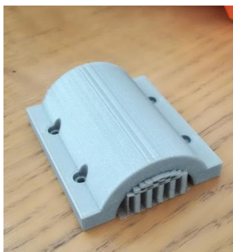
Obrázek 55: Dokončený tisk objímky bez odstranění podpor
