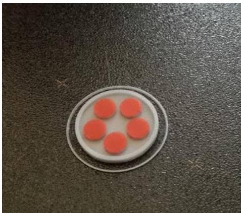
Obrázek 20: Hotový výtisk žetonu s použitím ColorPrint
