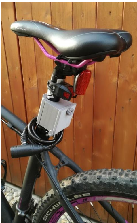
Obrázek 76: Umístění krabičky z PLA na kole
