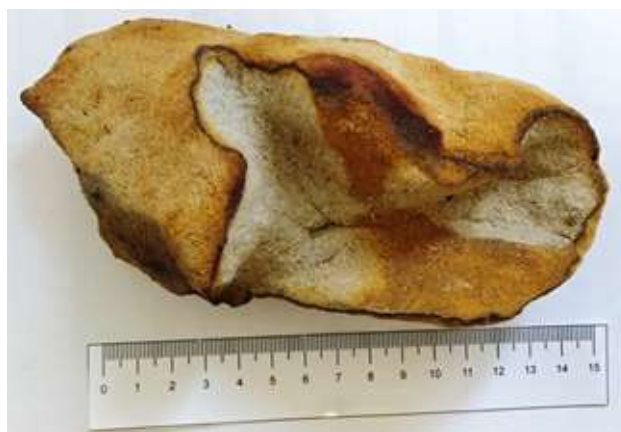
Obr. 31: Vzorek z dynamické sbírky – selektivní zvětrávání pískovce (ev. č. D6)
