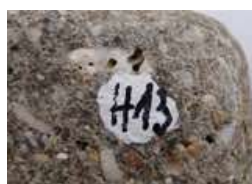
Obr. 3: Příklad označení vzorku permanentním fixem a ploškou z emailu, které je využito ve sbírce ZŠ Emy Destinové. Jedná se o unikátní číslo v tomto případě horniny (H).
