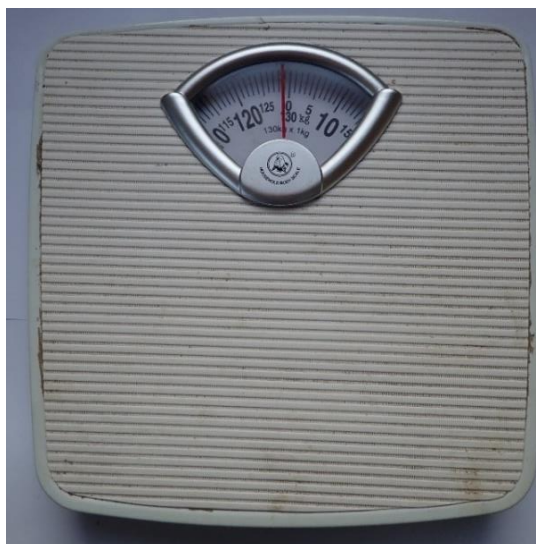
Obr. 3. Osobní váha s možností ruční kalibrace (Autorka práce, 2018).
