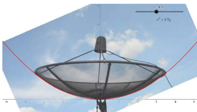
Obrázek 50: Parabolická anténa tvořena funkcí vstup
