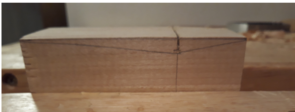
Obr. 9. – Naříznutí materiálu pilkou. Zdroj: Foto autorky
