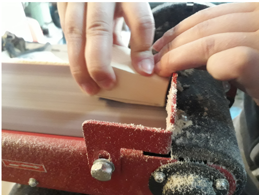
Obr. 8. – Pěšec – broušení přebytečného materiálu na stolní pásové brusce. Zdroj: Foto autorky.
