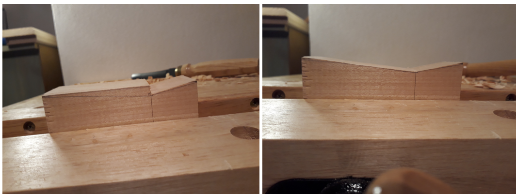
Obr. 10., 11. – Úběr materiálu dlátem. Zdroj: Foto autorky
