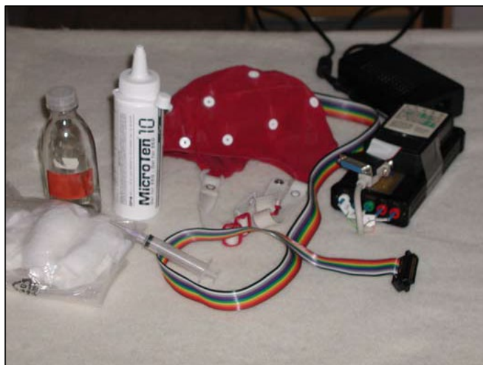
Obrázek č. 1 – zařízení pro záznam EEG: zesilovací jednotka, EEG čepice, vodivá pasta, injekce a pomůcka pro dezinfekci (Teplan, 2002)
