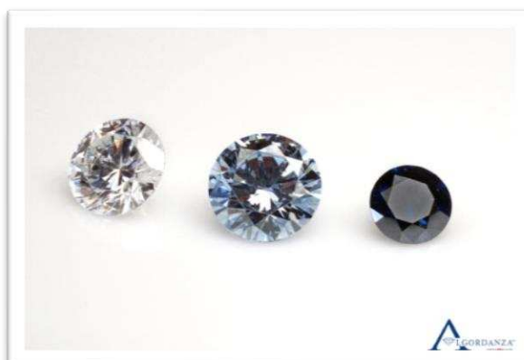
Obrázek 44: Diamanty z křemáčního popele. Typický namodralé zbarvení je způsobeno přítomností boru.
