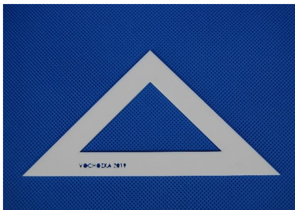
Obrázek 19: Trojúhelník bez stupnice vytvořený na 3D tiskárně.
