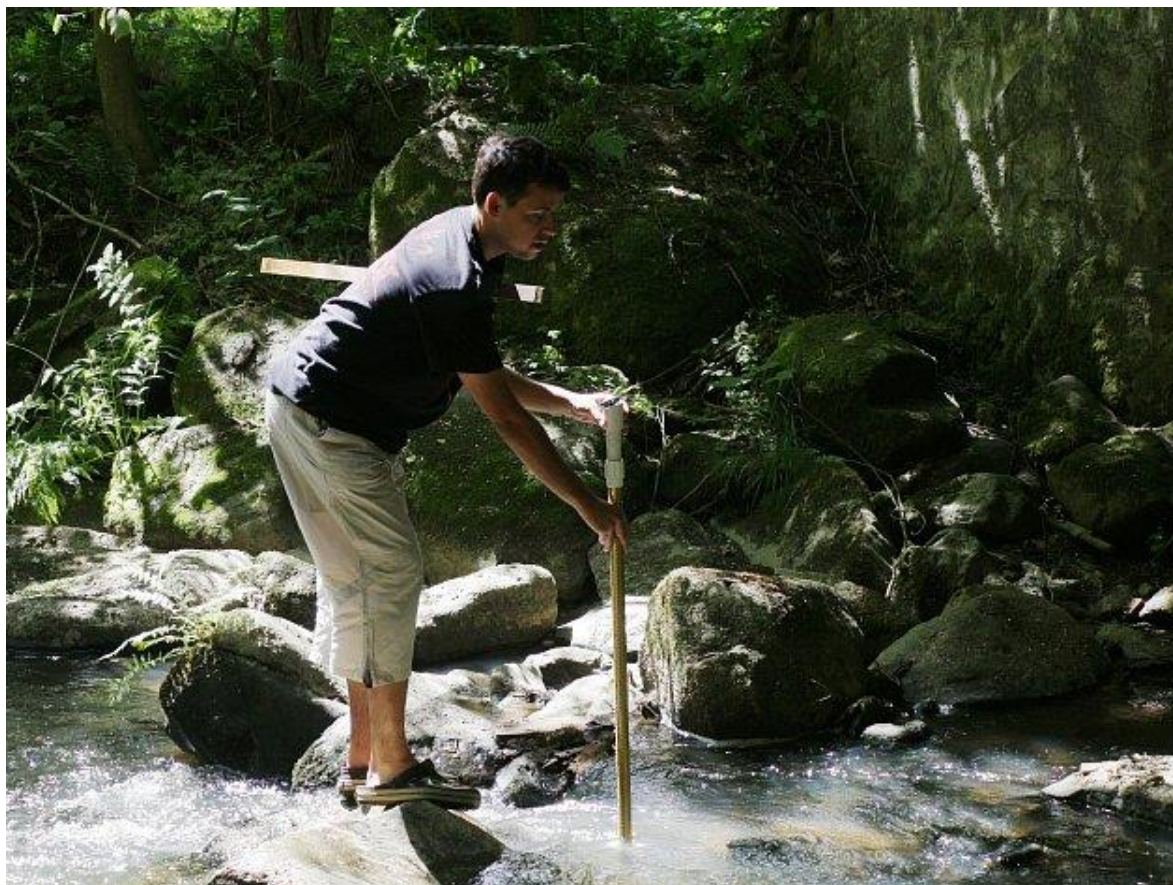
Příloha III. – Měření rychlosti průtoku vodního toku pomocí hydrometrické vrtule
