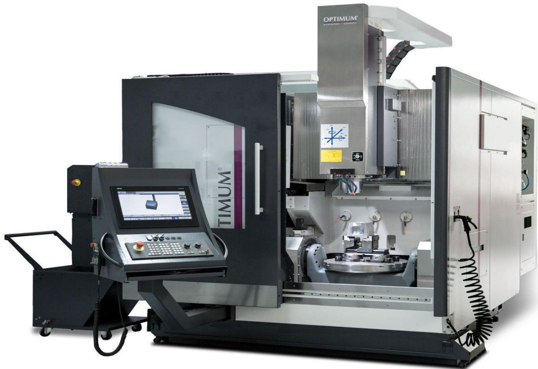
Obrázek 3 OPTIMUM Premium 5-osé univerzální obráběcí centrum [6]
