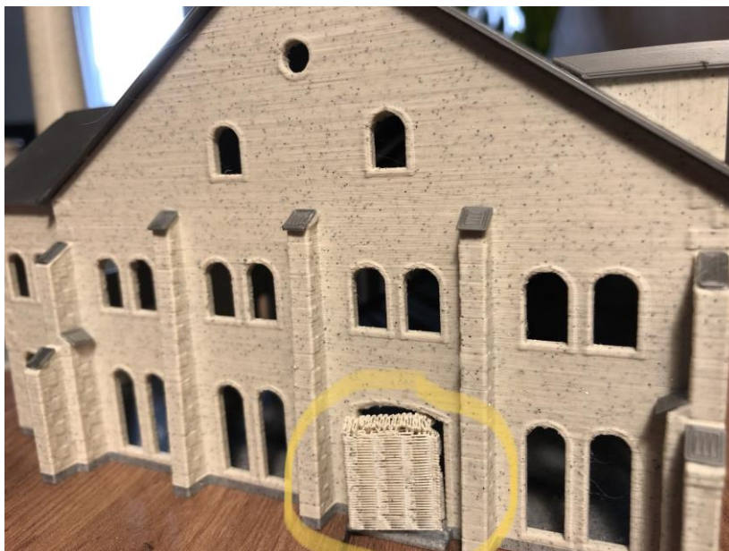
Obr. 37 Podpora okenního otvoru
