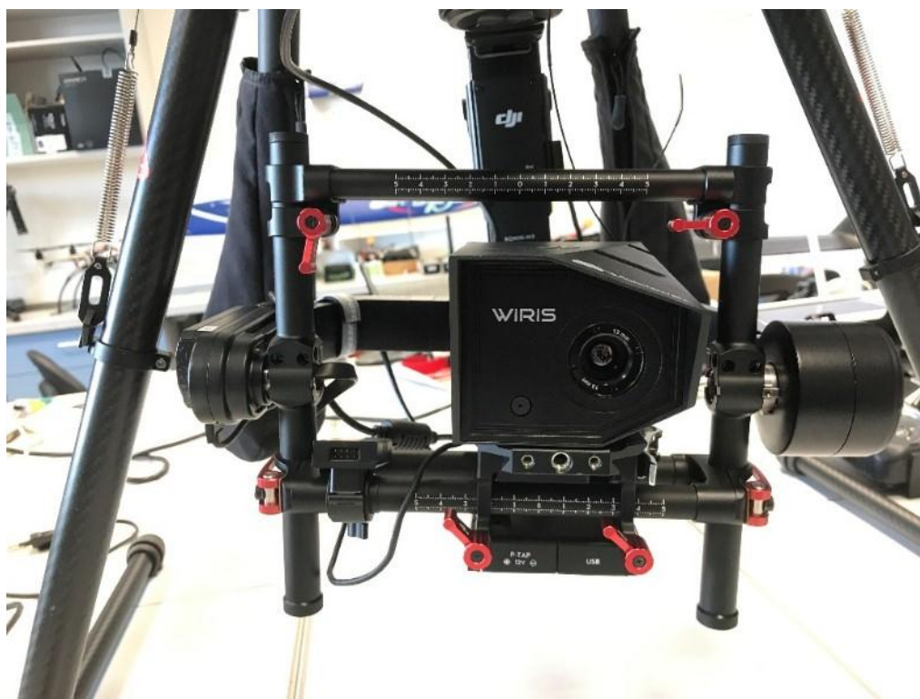
Obr. 1: Termální kamera instalovaná na dron (foto M.Novák ).
