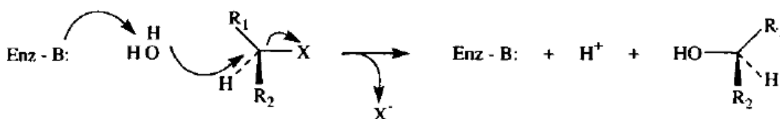
Obr. 3: Schéma bazické katalýzy molekulou vody (Převzato z Verschuieren a kol., 1993).
