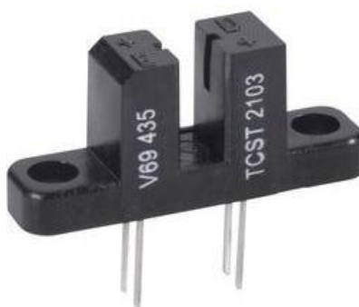
Obrázek 13 - Příklad konstrukce světelné závory s LED diodou a fototranzistorem
