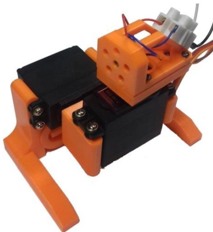
Obrázek 23 - Vytisknuté komponenty osazeny servomotory a laserem
