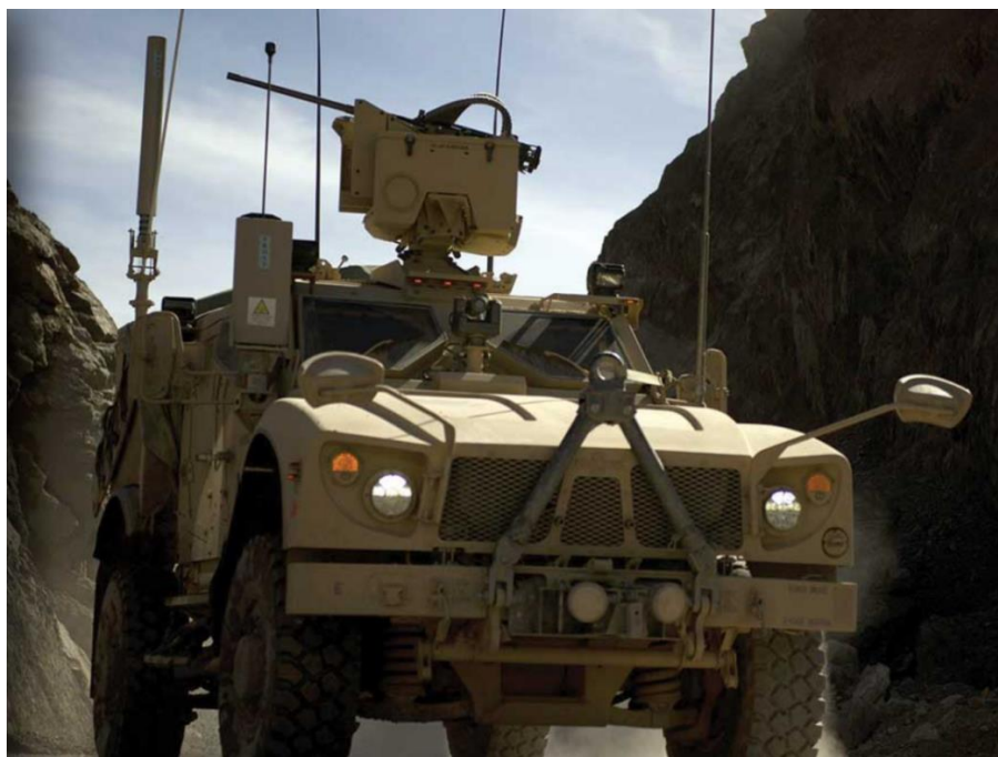
Obrázek 1- CROWS namontovaný na vozidle [20]
