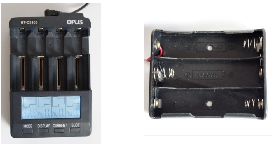
Obrázek 24: Nabíječka akumulátorů Opus BT-C3100 (vlevo) a držák Li-Ion článků 18650 se sériovým zapojením (vpravo)
