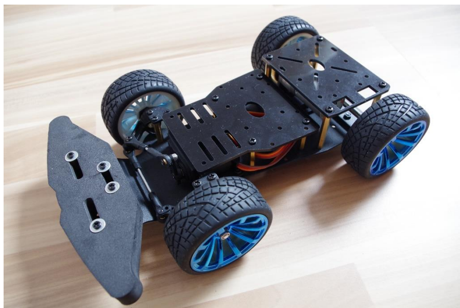
Obrázek 30: Sestavený podvozek RC auta
