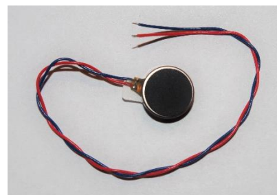
Obrázek 31: Vibrující DC motor
