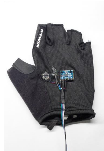
Obrázek 45: Zkompleťovaná elektronika rukavice v krabičce (vlevo), zkompleťovaná rukavice (vpravo)
