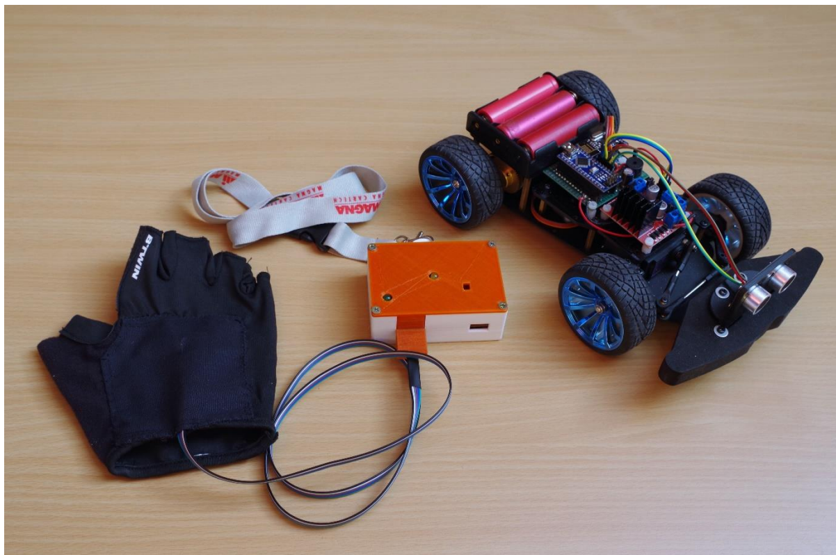
Obrázek 46: Konečná podoba sestavy inteligentní rukavice a RC auta
