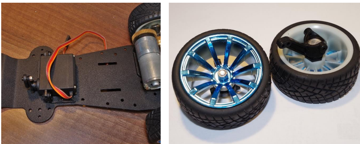
Obrázek 28: Uložení servomotoru (vlevo), přední pneumatiky s rameny (vpravo)
