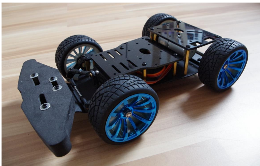
Obrázek 18: Sestavený podvozek od výrobce Elecrow
