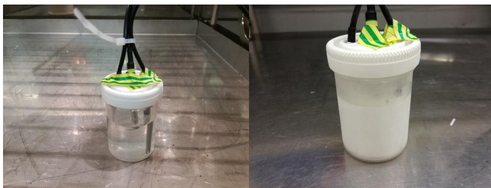
Obrázek 17: Vzorek s vloženými čidly připravený k měření (vlevo) a zamrzlý vzorek AdBlue® po jedné hodině
