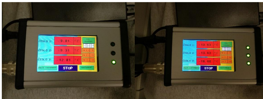
Obrázek 18: Zobrazení na displeji při dosažení první mezní teploty (vlevo) a zobrazení při dosažení třetí mezní teploty (vpravo).
