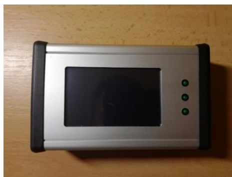
Obrázek 16: Hotové měřící zařízení po montáži v hliníkové krabičce
