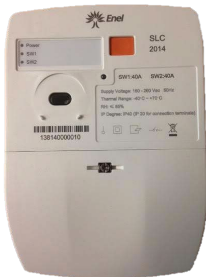
Obrázek 21: Inteligentní zařízení SLC, vlastní tvorba
