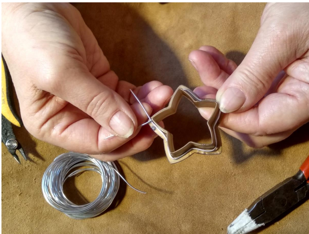
Vytvarování drátu podle formičky a vzájemné stočení konců
